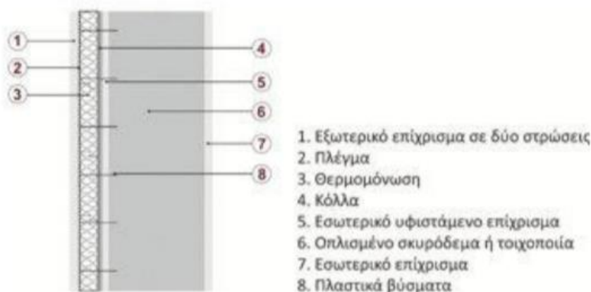
Εικόνα 47. Στρώσεις εξωτερικής θερμομόνωσης [75]
