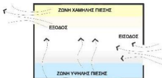
Εικόνα 10. Κατανομή πιέσεων μέσα στο χώρο [57]
