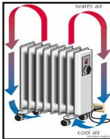
Εικόνα 41. Μετάδοση θερμότητας με συναγωγή [22]
