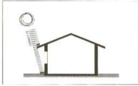
Εικόνα 21. Οριακή γωνία ηλιακής πρόσπτωσης την 21 η Ιουνίου [57]
