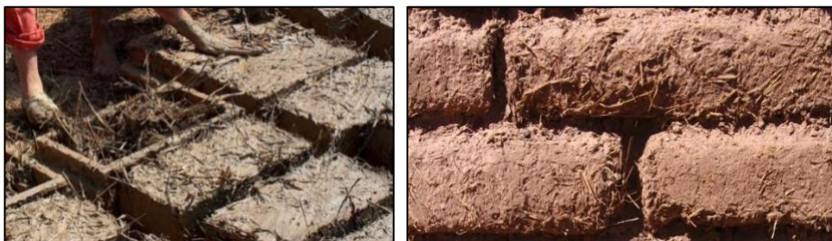
Εικόνα 1.1 Αριστερά: Παρασκευή πλήθων από λάσπη και άχυρο, Δεξιά: οι πλήνθοι έτοιμοι σε χρήση.
