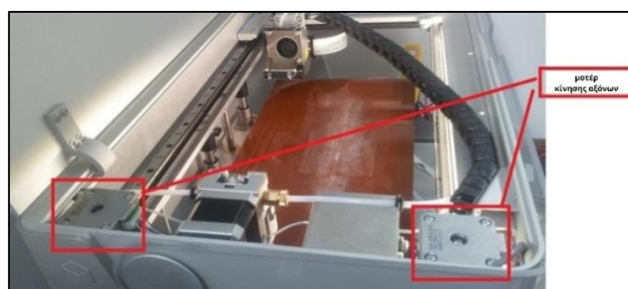
Εικόνα 3.10 Κάτοψη εκτυπωτή όπου φαίνονται τα μοτέρ κίνησης των αξόνων.
