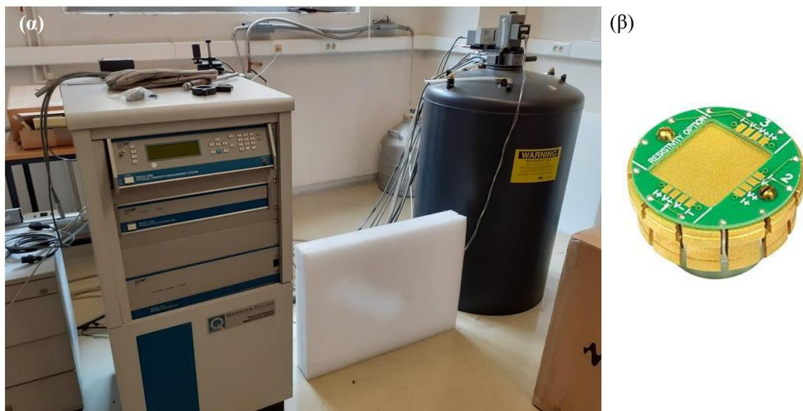
Σχήμα 2.8: (α) Διάταξη PPMS του Ε.Κ.Ε.Φ.Ε. «Δημόκριτος» (Quantum Design), (β) Δειγματοφορέας για τη μέτρηση της αντίστασης των δειγμάτων.
