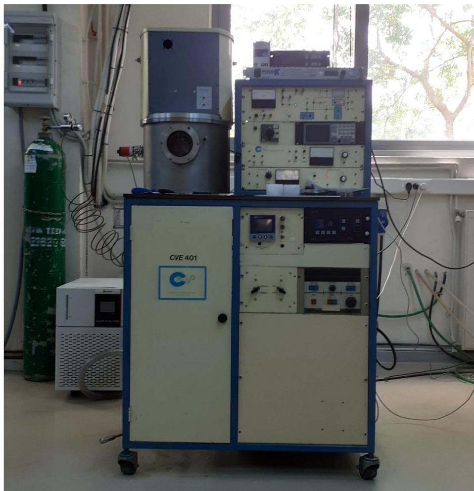
Σχήμα 2.2: Η διάταξη του θαλάμου μαγνητικά υποβοηθούμενης καθοδικής ιοντοβολής που χρησιμοποιήθηκε για την παρασκευή των δειγμάτων.
