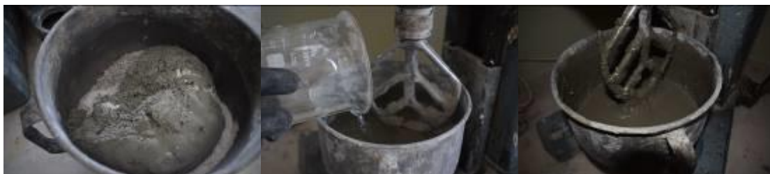
Εικόνα 23 Πειραματική διαδικασία παρασκευής νωπού κονιάματος.
