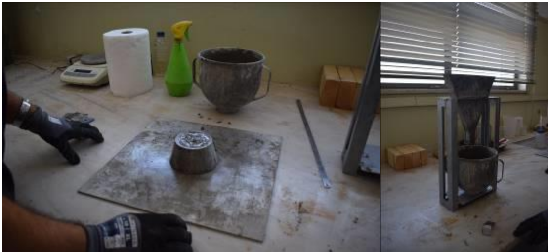
Εικόνα 21 Πειραματικός εξοπλισμός για τις δοκιμές Μικρή δοκιμή εξάπλωσης και Μικρή δοκιμή χοάνης V.
