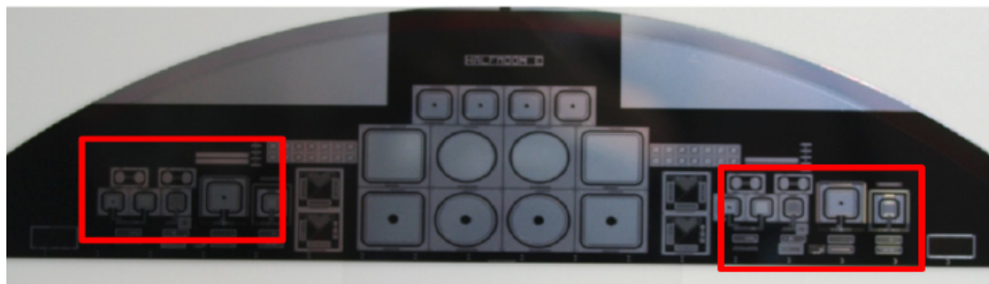
Σχ. 5.2: Πραγματική φωτογραφία ενός East halfmoon. Εντός των κόκκινων τετραγώνων φαίνονται η δεξιά και αριστερή μεριά στις οποίες βρίσκονται τα PQC flutes
