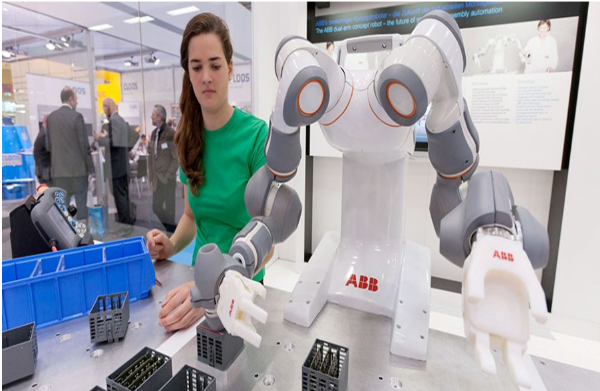
Σχήμα 1.04: Συνεργασία ανθρώπου - ρομπότ για τη συναρμολόγηση ηλεκτρονικών εξαρτημάτων
