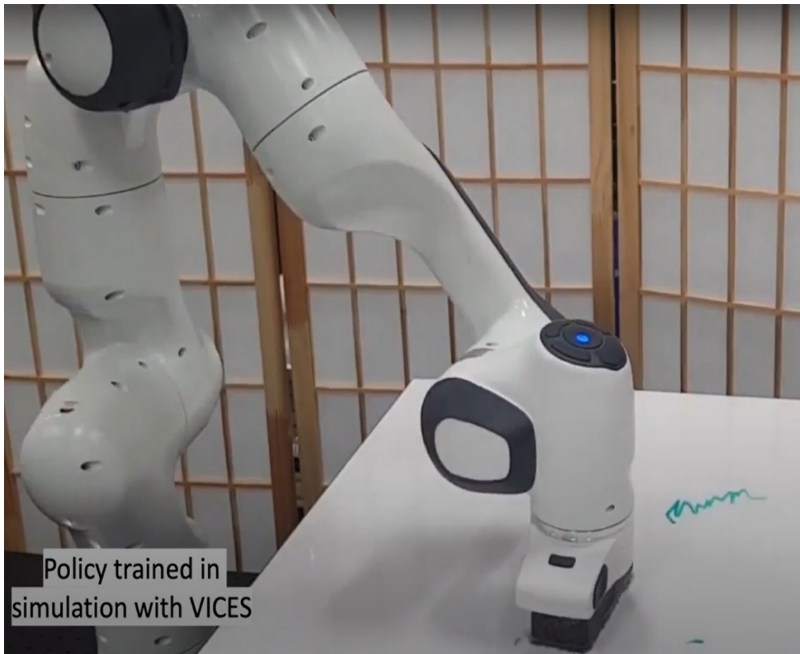
Σχήμα 1.06: Εφαρμογή ελέγχου εμπέδησης για τον καθαρισμό επίπεδης επιφάνειας
