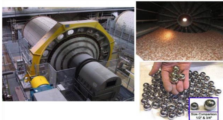
Εικόνα 13 Εξωτερικό, εσωτερικό και μέσα άλεσης σφαιρόμυλου (Mining Mill Operator Training, n.d.)
