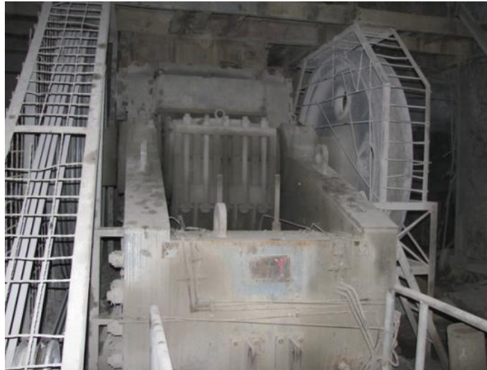
Εικόνα 6 Μεσαίου μεγέθους θραυστήρας σιαγόνων σε λειτουργία σε υπόγειο ορυχείο για σύνθλιψη μεταλλεύματος ROM πριν μεταφερθεί στην επιφάνεια στο Zawarhala της Ινδίας. (Haldar, 2013)
