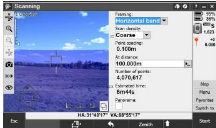
Εικ.2.7: Η οθόνη του tablet κατά την διαδικασία της σάρωσης με οριοθέτηση horizontal band
