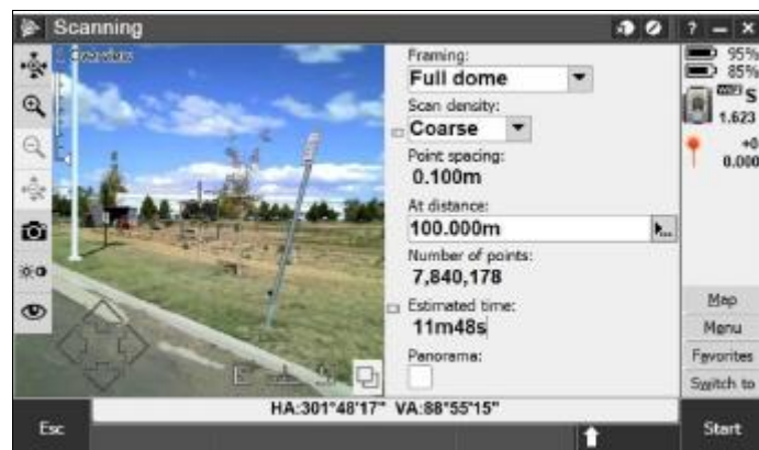
Εικ.2.8: Η οθόνη του tablet κατά την διαδικασία της πλήρους σάρωσης (full dome)
