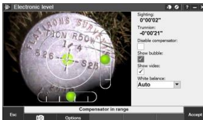
Εικ.2.4: Η οθόνη του tablet με το χειρισμό της plummet camera κατά την διαδικασία της κέντρωσης- οριζοντίωσης
