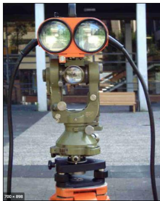
Εικ.1.6: Το EDM Distomat DI 10, προσαρμοσμένο σε θεοδόλιχο
