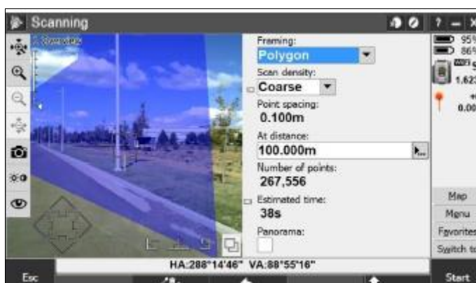
Εικ.2.6: Η οθόνη του tablet κατά την διαδικασία της σάρωσης με οριοθέτηση polygon
