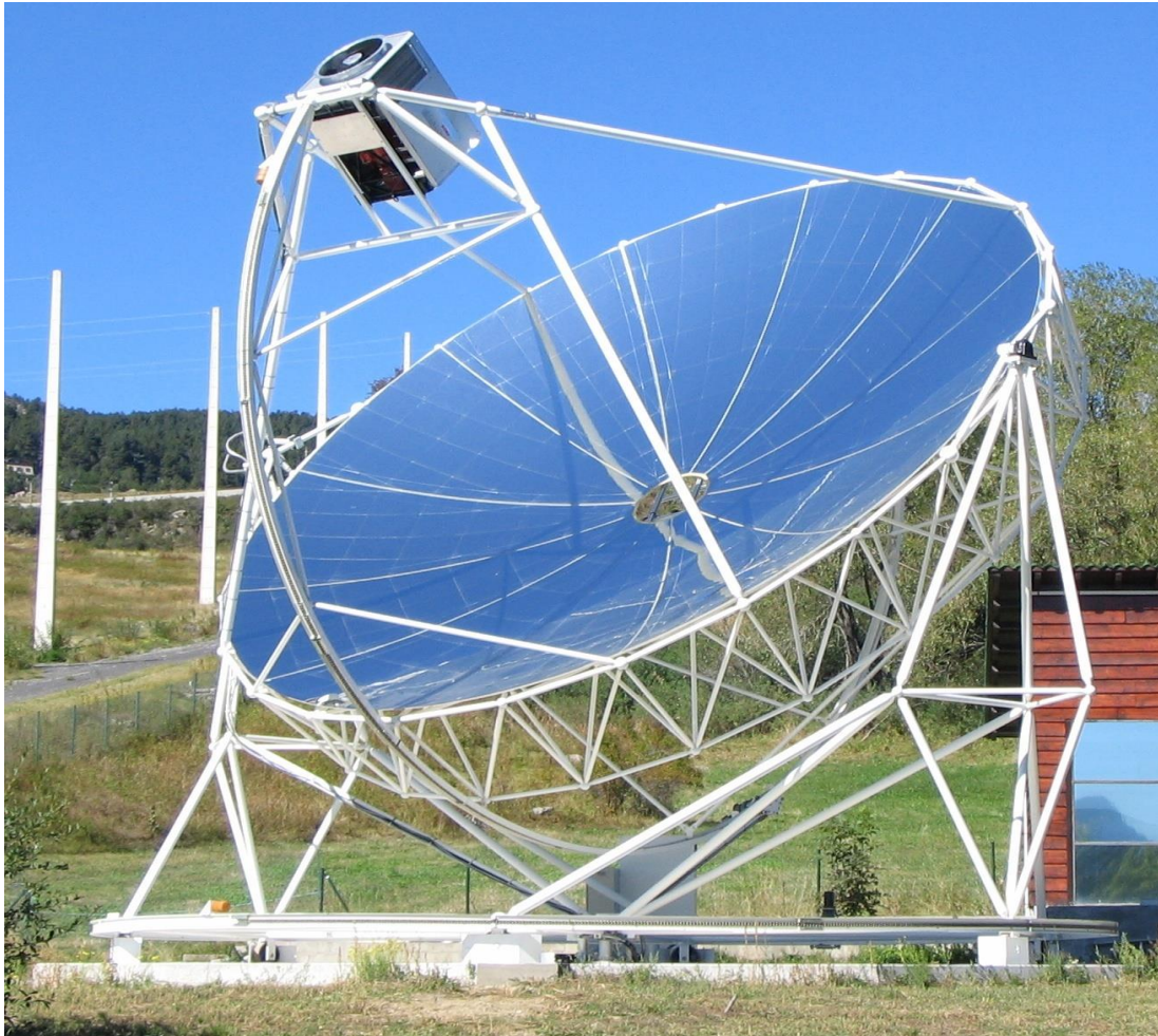
Εικόνα 1.17 Συλλέκτης με παραβολοειδές πιάτο σε σύνδεση με μηχανή Stirling [1.27]
