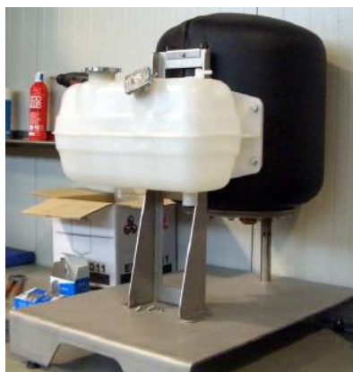
Σχήμα 5.8: Σύστημα ψύξης και δοχείο αποθήκευσης νερού
