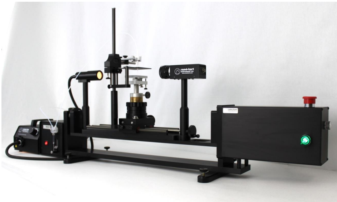
Εικόνα 4.15: Πειραματική διάταξη μετρήσεων γωνίας επαφής (Rame-hartmodel 590).
