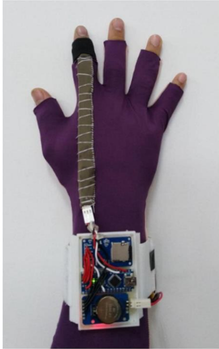
Εικόνα 3.1: Γάντι με αισθητήρα από MWCNTs/PDMS για την καταγραφή δονήσεων [47].
