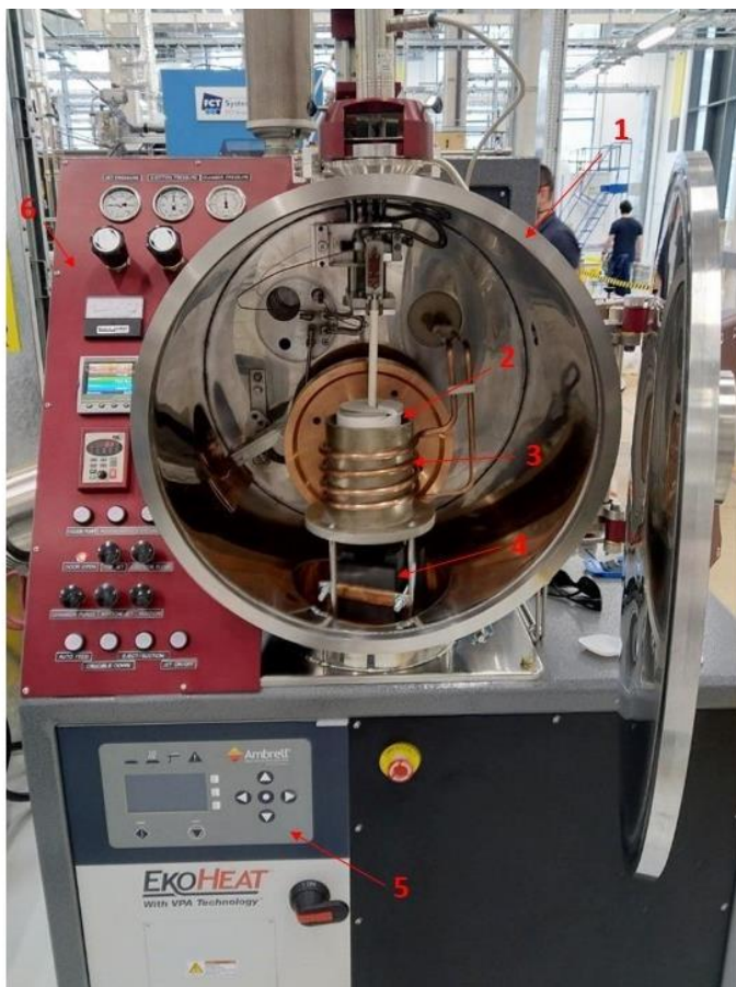
Εικόνα 6. Εξοπλισμός Arcast - SC 100 του University of Sheffield που χρησιμοποιήθηκε για την χύτευση του υλικού.
