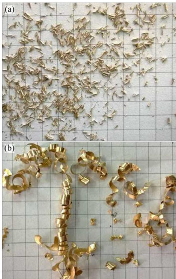
Εικόνα 3. Μορφολογίες ρινισμάτων (a) ασυνεχή ρινίσματα από ορείχαλκο με προσθήκη μολύβδου και (b) συνεχή ελικοειδή ρινίσματα από κατεργασία κοινού ορείχαλκου [24].
