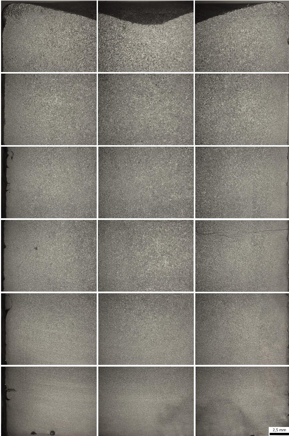
Εικόνα 16. Επιφάνεια δείγματος A2 έπειτα από προσβολή με διάλυμα Δ4 (πυκνό HNO 3 ).
