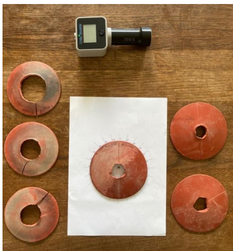
Εικόνα 3.6 Προετοιμασία μονωτήρων GNS3 και GNP 4 με περίβλημα ελαστομερούς σιλικόνης
