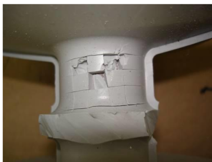
Εικόνα 2.5. Παράδειγμα καλής συγκόλλησης [25]
