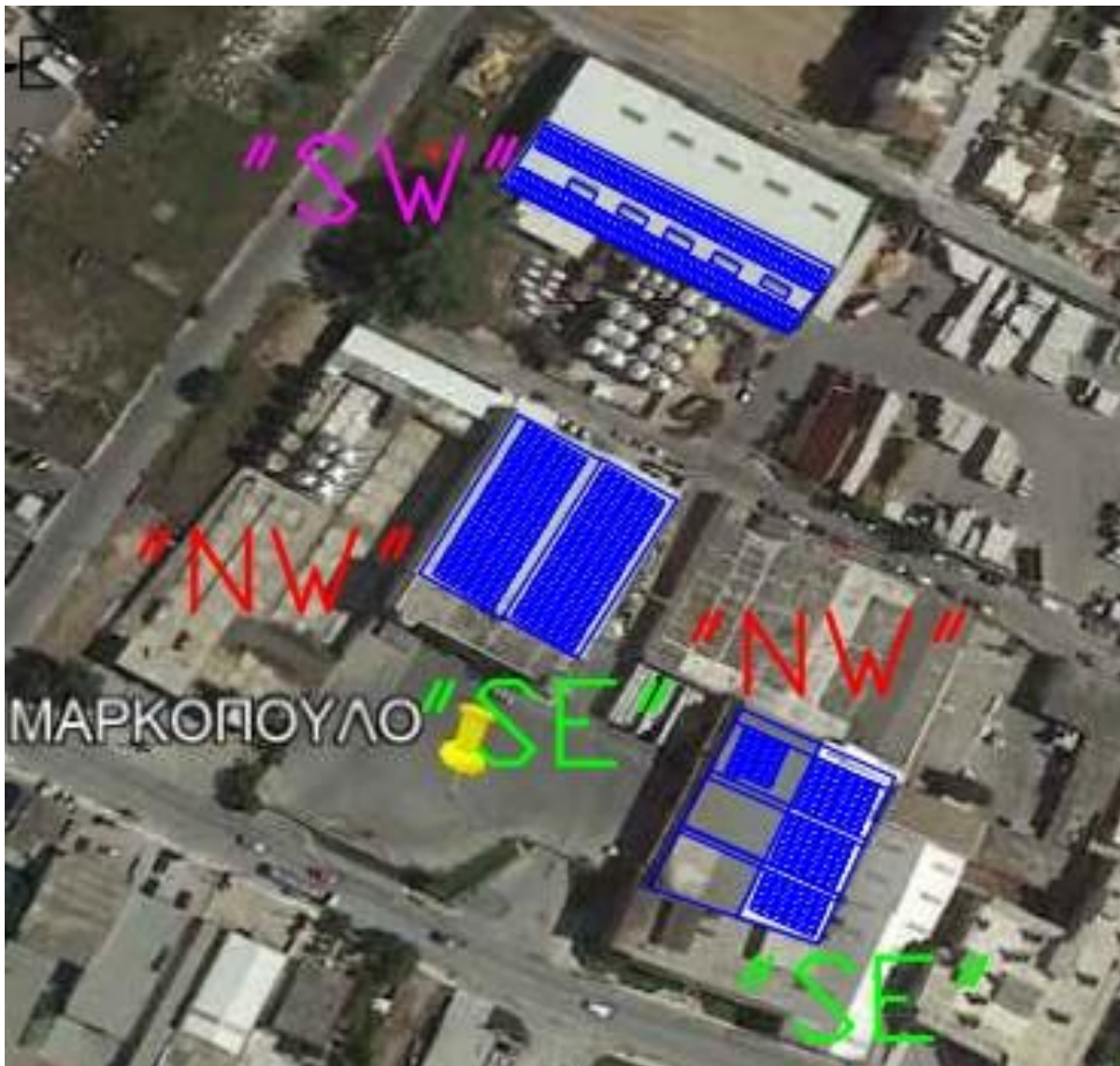
Σχήμα 1.4: Σχηματική απεικόνιση σε περιβάλλον AutoCad της χωροθέτησης των φωτοβολταϊκών στοιχείων στις στέγες των κτηριακών εγκαταστάσεων στο Μαρκόπουλο Αττικής. (Πηγή: πρωτότυπο)
