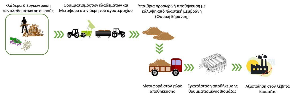
Σχήμα 2.2: Σχηματική απεικόνιση των δραστηριοτήτων της εφοδιαστικής αλυσίδας της βιομάζας (Πηγή: πρωτότυπο)
