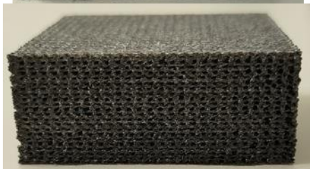
Εικόνα 30 Δοκίμιο Gyroid 50% πριν και μετά τη θλίψη.
