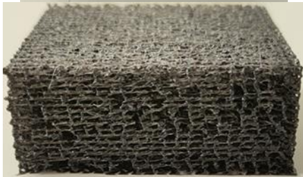
Εικόνα 29: Δοκίμιο Gyroid 40% πριν και μετά τη θλίψη.
