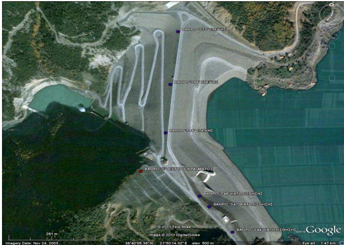
Σχήμα 7.3: Δορυφορική εικόνα όπου φαίνεται το σημείο με κωδικό E του δικτύου, τα τρία βάθρα της στέψης με κωδικούς (S64,S68,S73) και τα τρία βάθρα για τον έλεγχο της κατολίθησης με κωδικούς (S44,S47,S48) όπου μετρήθηκαν με GPS – Satellite image showing the reference point with code E of the network, the three control points of the crest with codes (S64,S68,S73) and the three control points with codes (S44,S47,S48) for the control the landslide were measured by GPS, Πηγή : Google Earth
