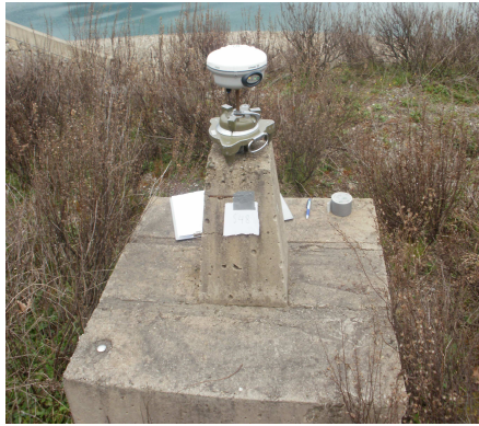
Σχήμα 5.20: Το σημείο ελέγχου με κωδικό S48 για τον έλεγχο της κατολίσθησης του αριστερού πρανούς - The control point with code S48, to control the landslide on the left abutment
