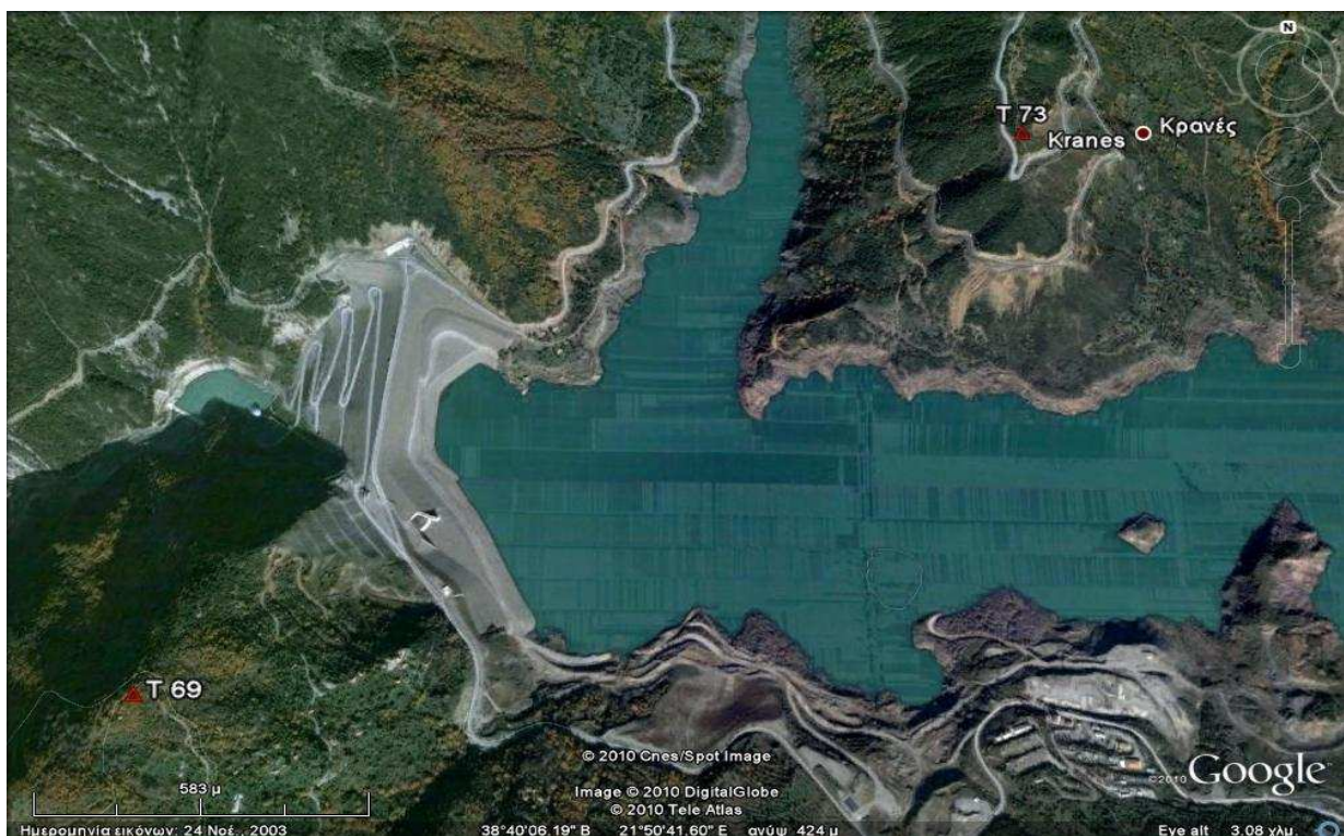
Σχήμα 5.4 : Δορυφορική εικόνα όπου φαίνονται οι θέσεις των τριγωνομετρικών σημείων της ΓΥΣ – Satellite image showing the positions of trigonometric points of G.Y.S., Πηγή : Google Earth
