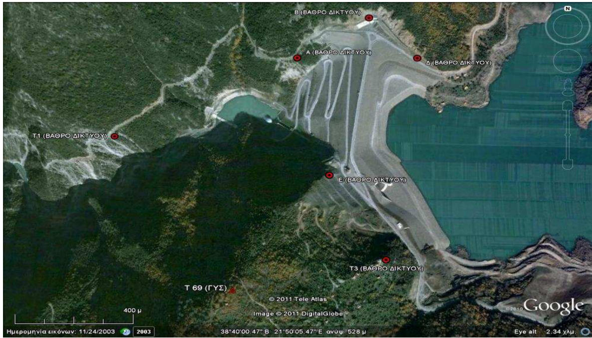
Σχήμα 5.14 : Θέσεις σημείων αναφοράς του τριγωνομετρικού δικτύου του φράγματος όπου μετρήθηκαν με GPS στις 28/03/2011 – Positions of reference points trigonometric network of the dam measured by GPS at 28/03/2011, Πηγή : Google Earth
