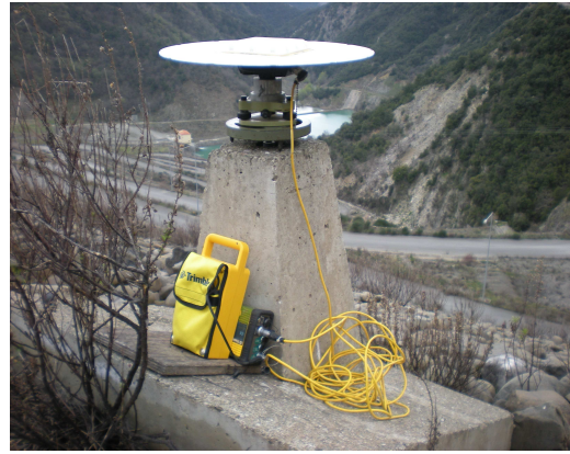
Σχήμα 5.13: Σημείο ελέγχου στέψης (κατάντη) με κωδικό S73 - Control point of crest (downstream) with code S73
