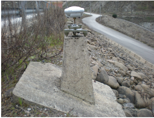
Σχήμα 5.12 : Σημείο ελέγχου στέψης (κατάντη) με κωδικό S64 – Control point of crest (downstream) with code S64
