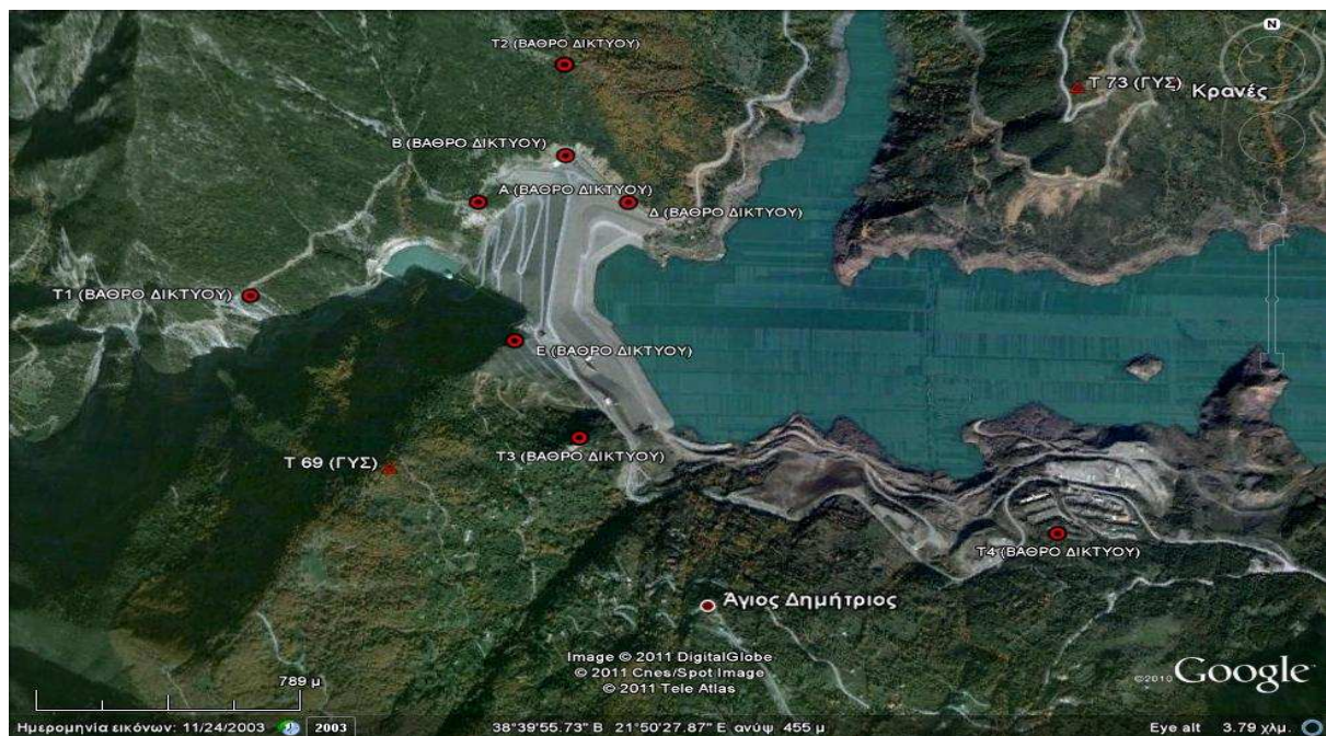
Σχήμα 5.3 : Θέσεις σημείων αναφοράς του τριγωνομετρικού δικτύου του φράγματος και της ευρύτερης περιοχής – Positions of reference points of the trigonometric network of the dam and surrounding area, Πηγή : Google Earth
