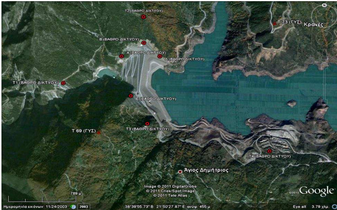
Σχήμα 5.18 : Θέσεις των σημείων αναφοράς του τριγωνομετρικού δικτύου του φράγματος όπου μετρήθηκαν με GPS στις 29/03/2011 – Positions of reference points trigonometric network of the dam measured by GPS at 29/03/2011, Πηγή : Google Earth
