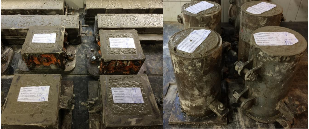
Εικόνα 10.3 Κυβικά και κυλινδρικά δοκίμια
