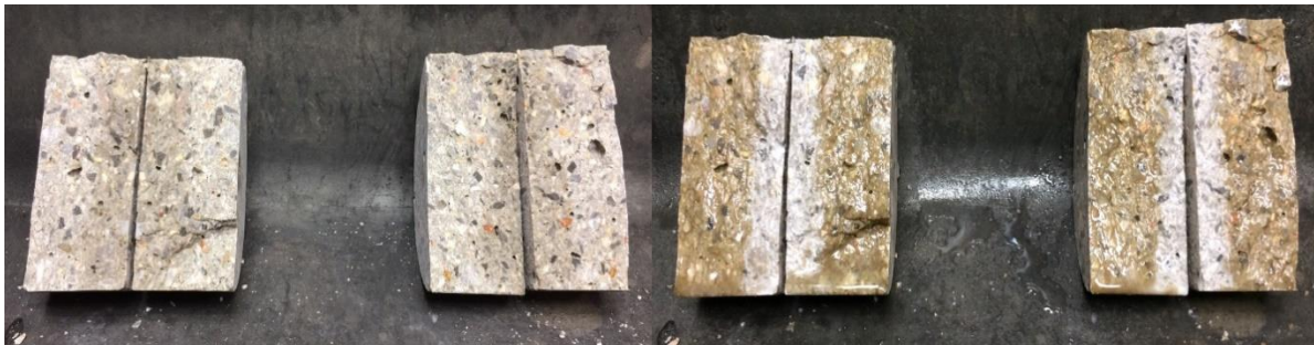
Εικόνα 5.2 Εμφάνιση δυο θραυσμένων δοκιμίων, πριν (αριστερά) και μετά (δεξιά) τον ψεκασμό τους με διάλυμα AgNO_3 κατά τη δοκιμή NT Build 492(1999)
