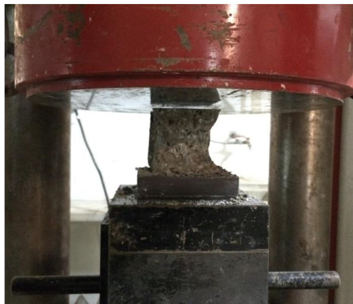
Εικόνα 10.2 Θραύση κυβικού δοκιμίου στο ΕΟΣ του ΕΜΠ
