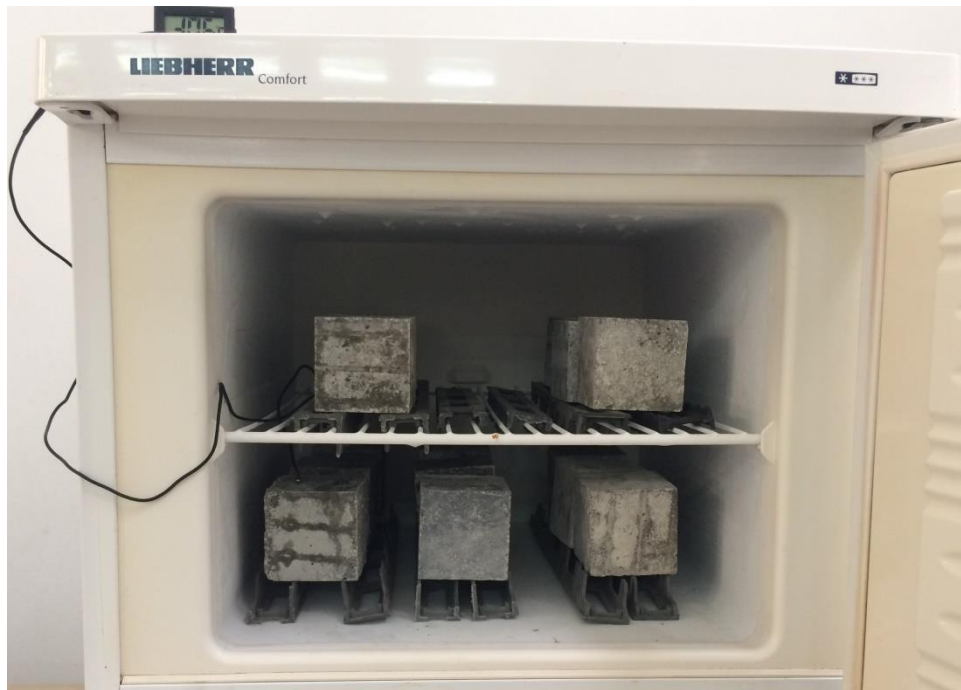
Εικόνα 5.3 Διατεταγμένα δοκίμια κατά το στάδιο της κατάψυξης για τη δοκιμή ψύξης-απόψυξης
