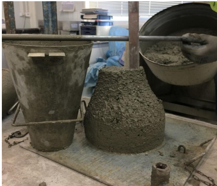
Εικόνα 10.1 Εκτέλεση δοκιμής κάθισης στο νωπό σκυρόδεμα
