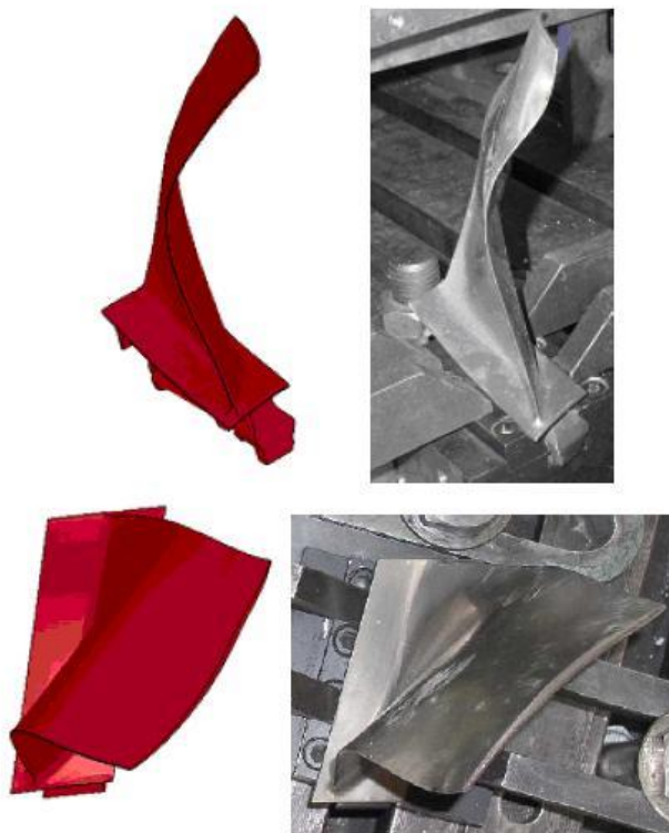
Εικόνα 7.21: Αποτέλεσμα επίλυσης της πλαστικής κρούσης κυλινδρικού σωματιδίου πάγου με το πτερύγιο του συμπίεστη (Πηγή : Y. Chuzel et al “Development Of Hail Material Model For High Speed Impacts On Aircraft Engine” 2010)
