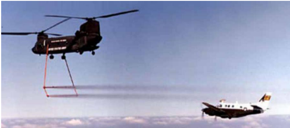
Εικόνα 3.6: Εναέρια δοκιμή ελικοφόρων κινητήρων (Πηγή : MDS Aero Support Corporation "MDS Proprietary Information"2005)
