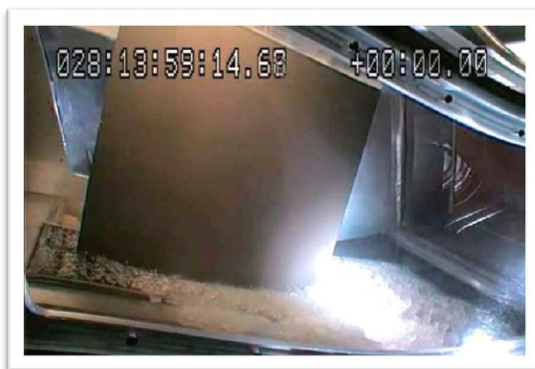
Εικόνα 2.5: Εσωτερική Παγοποίηση με κρυστάλλους πάγου σε κανάλι που προσομοιώνει το πέρασμα από το συμπιεστή χαμηλής πίεσης στο συμπιεστή υψηλής πίεσης (Πηγή : J. Mason “ Understanding Ice Crystal Accretion and Shedding Phenomenon in Jet Engines Using a Rig Test ” 2011)
