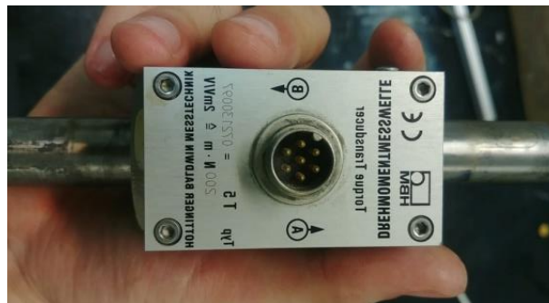
Εικόνα 14. Αισθητήρας ροπής της πειραματικής διάταξης
