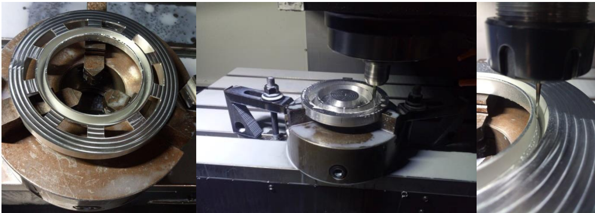
Εικόνα 11. Απεικόνιση διαδικασίας τοποθέτησης, στερέωσης και κατεργασίας σε CNC.
