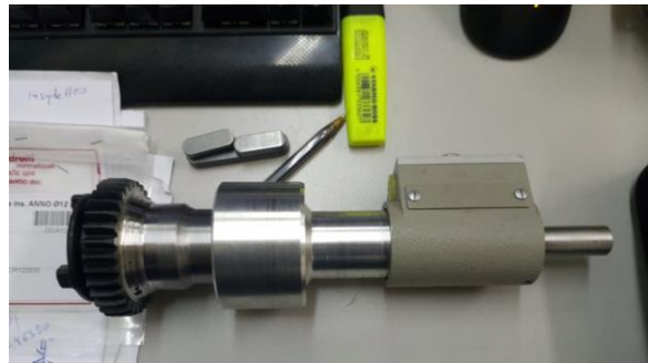
Εικόνα 16. Σύνδεση αισθητήρα ροπής με πολύσφηνο του άξονα εισόδου μέσω ειδικού συνδέσμου
