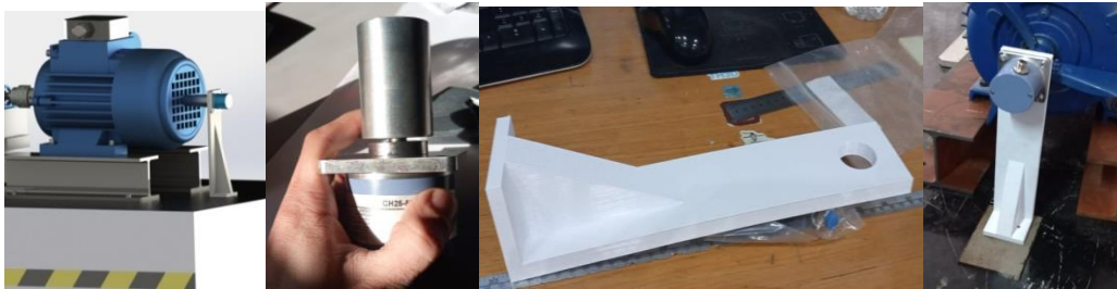
Εικόνα 20. Κατασκευή και τοποθέτηση συνδέσμου συγκράτησης στην βάση στήριξης
