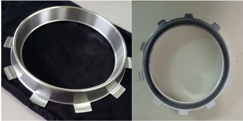
Εικόνα 12. Πρωτότυπος δίσκος τριβής κωνικής γεωμετρίας V-Shape
