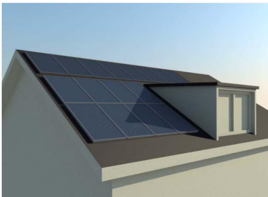
Σχήμα 2.4.6.1: Μερική σκίαση φωτοβολταϊκών σε στέγη
