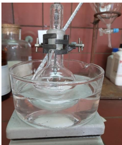
Εικόνα 2-1 Πειραματική διάταξη κατά την παρασκευή του NADES και το σχηματισμένο NADES
