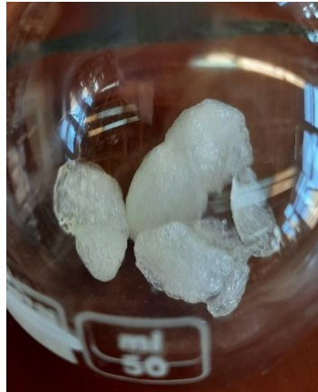
Εικόνα 2-12 Υδρογέλη με απορροφημένο λάδι
