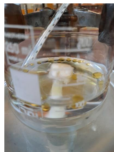
Εικόνα 2-11 Πειραματική διαδικασία με χρησιμοποιούμενο λάδι το ελαιόλαδο
