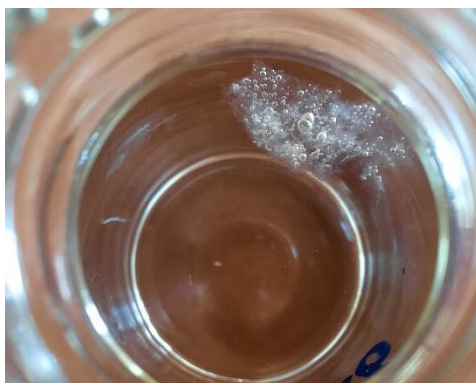
Εικόνα 2-8 Διογκωμένη υδρογέλη μέσα σε διάλυμα HCl
