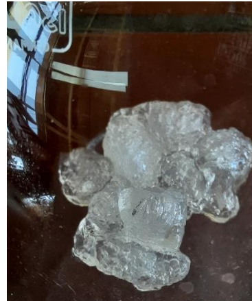
Εικόνα 2-12 Υδρογέλη με απορροφημένο λάδι
