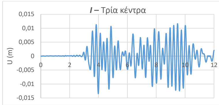
Εικόνες 6.23 - Χρονοϊστορία εγκάρσια παραμόρφωσης κλείδας χάραξης τριών κέντρων
