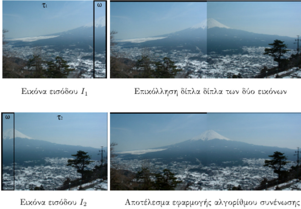
Σχήμα 4.1: Δίνονται δύο φωτογραφικές λήψεις I_1 και I_2 του ίδιου τοπίου που απεικονίζουν γειτονικές ως προς τον ορίζοντα περιοχές του \tau_1 \cup \omega και \omega \cup \tau_2 . Η επικόλλησή τους δίπλα-δίπλα φυσικά δεν έχει το επιθυμητό αποτέλεσμα και δημιουργείται μία «ραφή» (π.χ. λόγω μη ομοιόμορφης φωτομετρικής απόκρισης της κάμερας). Ο αλγόριθμος των Levin et al. αποδίδει ένα φυσικό οπτικά αποτέλεσμα [5].
