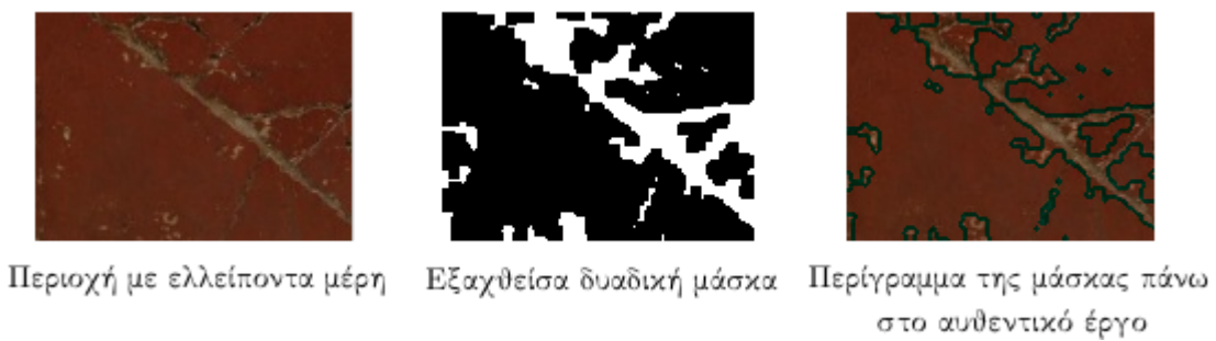
Σχήμα 2.2: Εξαγωγή δυαδικής μάσκας για μικρό τμήμα με ρωγμές της τοιχογραφίας Ακολουθία Ανδρών και υπέρθεση του περιγράμματος της μάσκας πάνω στο αυθεντικό έργο.
