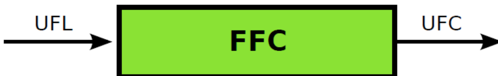
Σχήμα 1.8 Ο FFC παράγει κώδικα C++ σε UFC format με είσοδο μια μεταβολική έκφραση σε γλώσσα UFL
