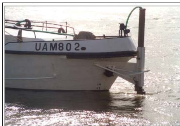
Εικόνα 2.18. Εγκατάσταση μετατροπέα πάνω από την πλώρη (IHO, 2010).
