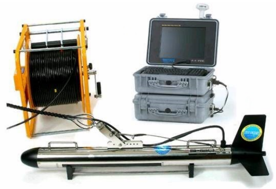
Εικόνα 2.63. Απεικόνιση του εξοπλισμού της συσκευής σόναρ πλευρικής σάρωσης (Wu et al., 2021).
