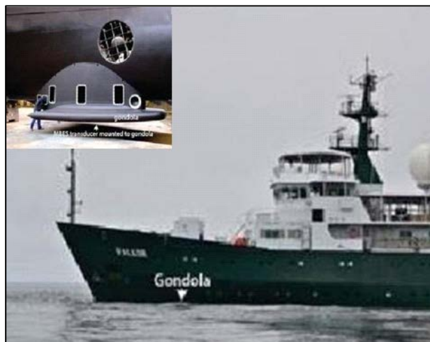
Εικόνα 2.17. Μορφοτροπέας «gondola» (Lucieer et al., 2018).
