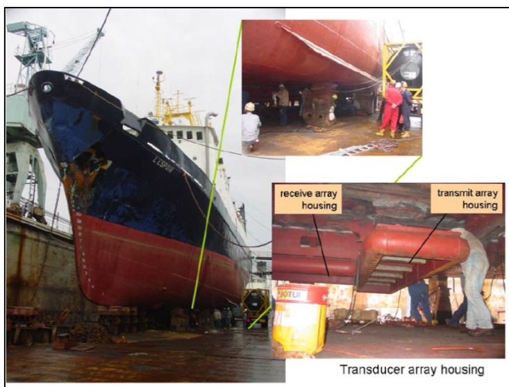
Εικόνα 2.41. Υδρογραφικό σκάφος έρευνας που χρησιμοποιεί ηχοβολιστικό πολλαπλής δέσμης. Είναι εφοδιασμένο με μια συστοιχία δεκτών που έχει μήκος 3m και είναι προσανατολισμένο κατά μήκος της τρύπιδας του πλοίου. Εμφανίζεται μόνο ένα τμήμα της συστοιχίας μετάδοσης, το οποίο είναι κάθετο στους δέκτες και έχει μήκος 6m (Orange et al., 2008).
