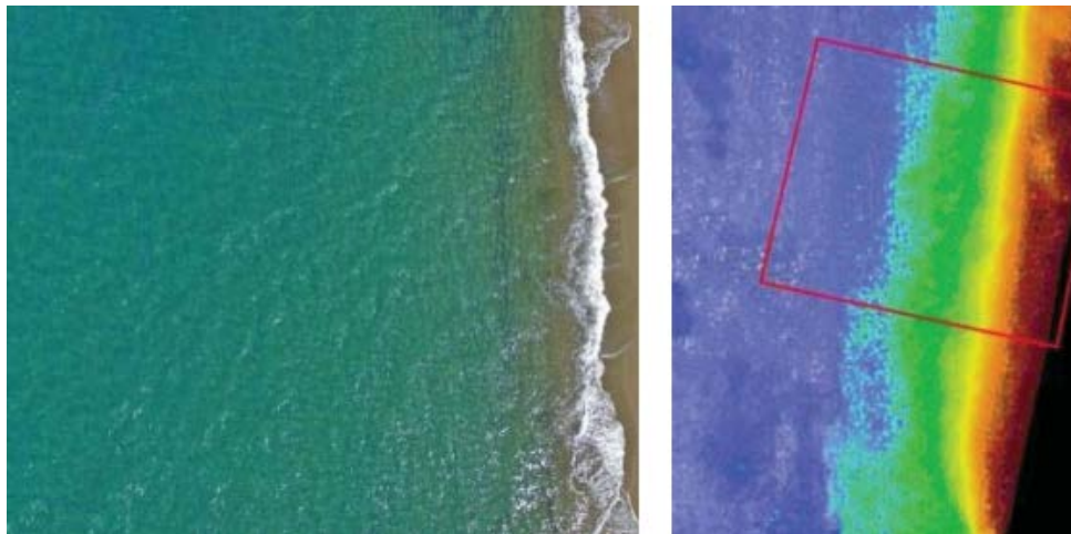
Εικόνα 3.26. Απεικόνιση εικόνα RGB από UAV (αριστερά) και βαθυμετρικού χάρτη με τη χρήση της εμπειρικής μεθόδου και του αλγορίθμου Stumpf (δεξιά) (Rossi et al., 2019).
