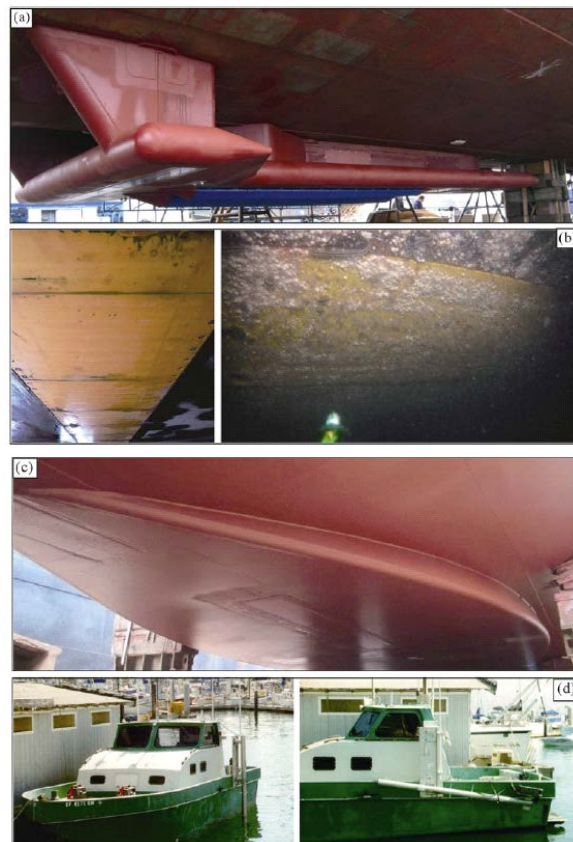
Εικόνα 2.40. Μέθοδοι εγκατάστασης μορφοτροπέα. (a) gondola, (b) flush mounted, (c) blister, (d) φορητή εγκατάσταση δίπλα στο πλοίο (IHO, 2010).
