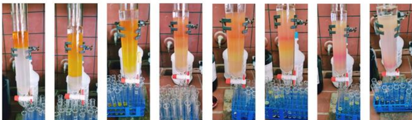
Εικόνα 48. Πορεία καθαρισμού του προϊόντος με χρωματογραφία στήλης
