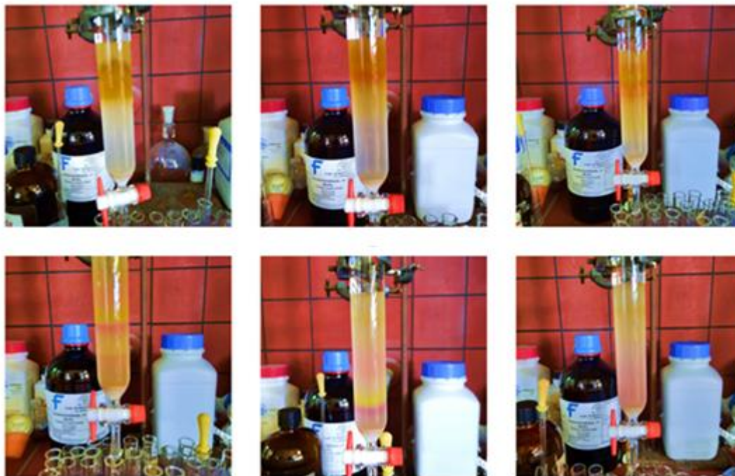
Εικόνα 50. Πορεία διαχωρισμού προϊόντος από ακαθαρσίες
