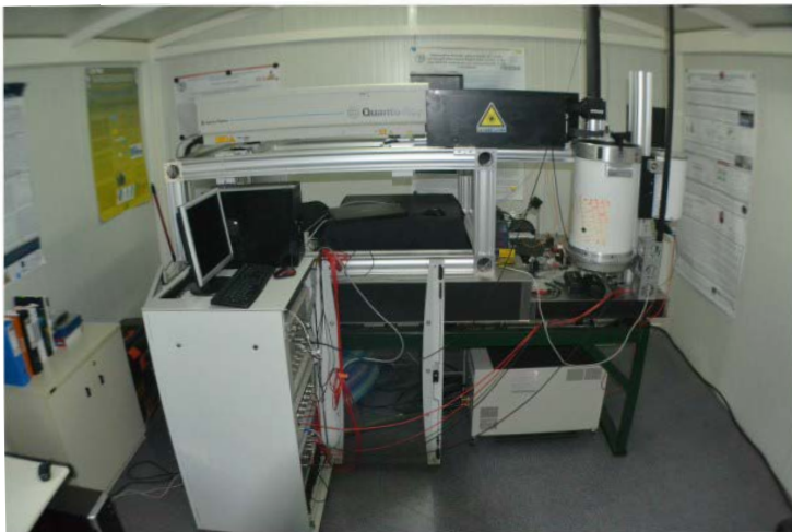
Εικόνα 3—1. EOLE Raman Lidar: Η διάταξη 6 μηκών κύματος του Ε.Μ.Π. 68
