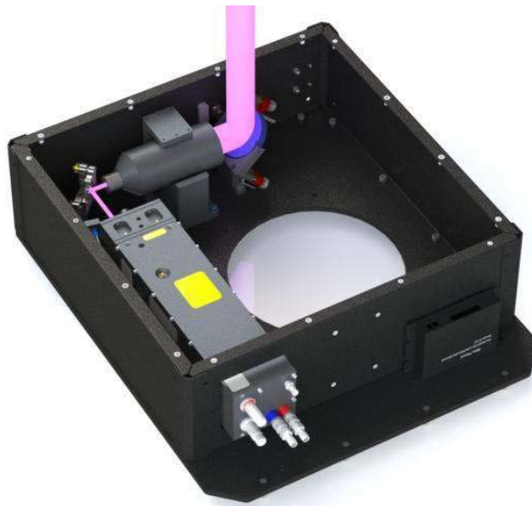
Εικόνα 3—4. Σχηματική αναπαράσταση του συστήματος εκπομπής δέσμης της συσκευής (εικόνα από το εγχειρίδιο). Η δέσμη Laser παράγεται από την πηγή και ανακλάται από το πρώτο κάτοπτρο προς τον διευρυντή δέσμης. Στην έξοδο της από το διευρυντή έχει μεγεθυνθεί και ανακλάται από το δεύτερο κάτοπτρο προς την ατμόσφαιρα.
