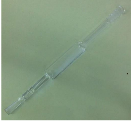
Εικόνα 2-2. Πεπλατυσμένη κυψελίδα για υγρά δείγματα τύπου WG-813-Q της εταιρίας Wildmand για EPR.
