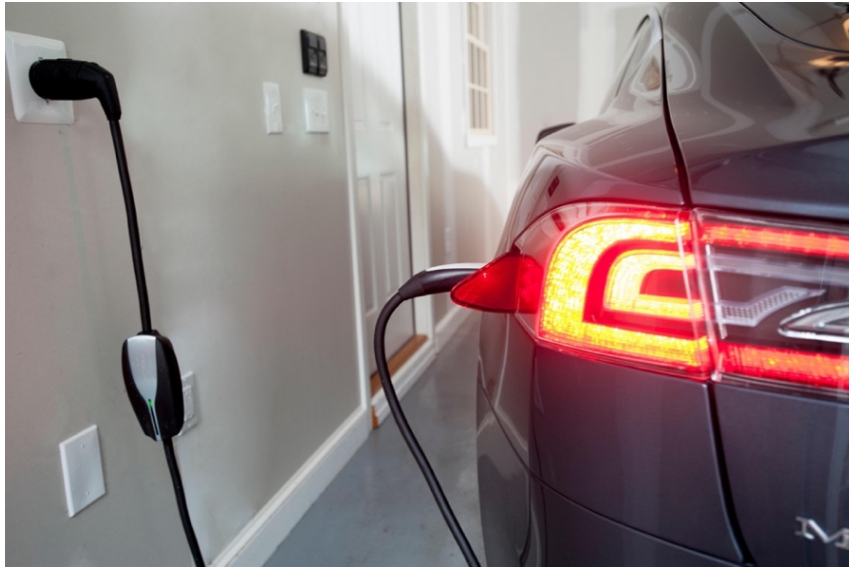
Εικόνα 12. Απλή οικιακή φόρτιση ( www.evbite.com )
