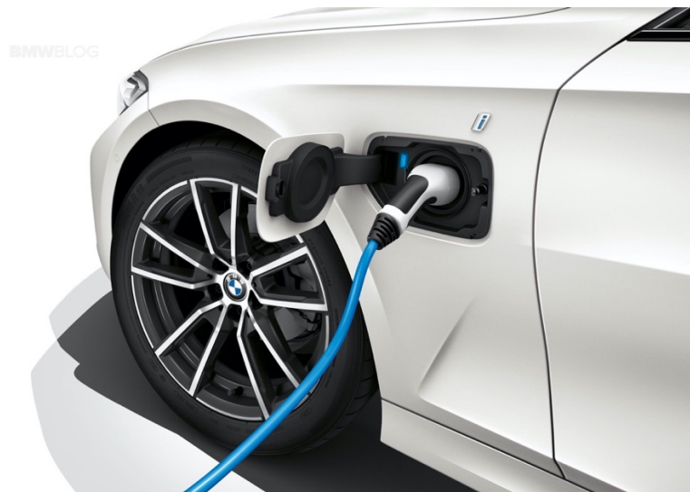
Εικόνα 6. Δεύτερο ντεπόζιτο, αλλά μόνο για φόρτιση του ηλεκτροκινητήρα, σε επιβατικό PHEV μοντέλο της BMW ( www.bmw.de )
