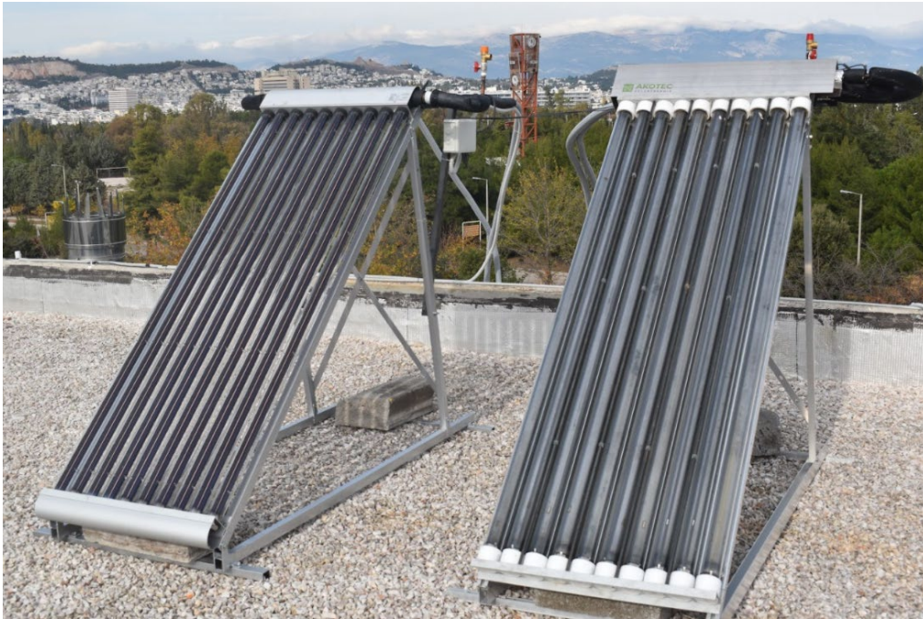
Εικ. 2.3 Τμήμα του νέου ηλιακού συλλέκτη κενού του συστήματος SWS-Heating (δεξιά). Αριστερά απεικονίζεται ο εμπορικός συλλέκτης κενού OEM Vario 1000 της εταιρείας Akotec
