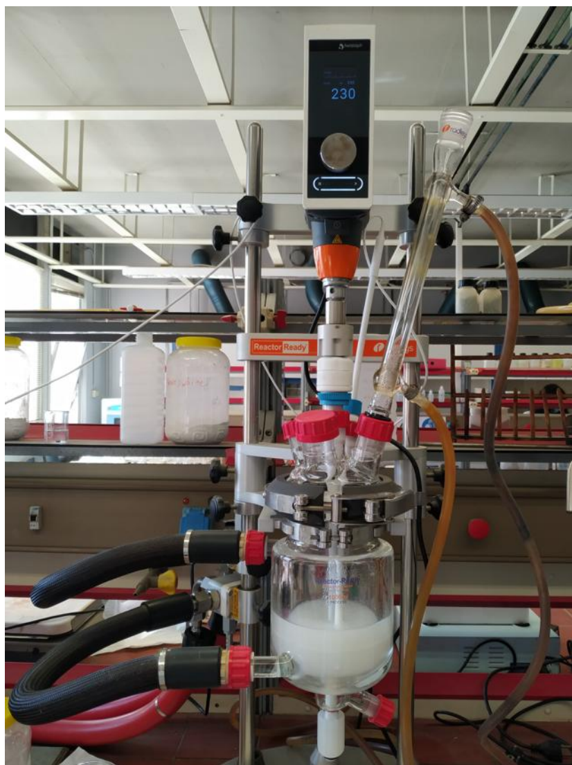
Εικόνα 22: Διάταξη δοκιμής Chapelle με αντιδραστήρα σε λειτουργία
