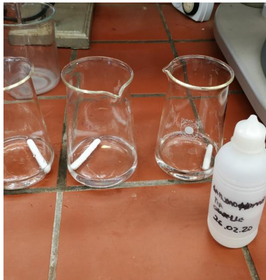
Εικόνα 19: Διηθημένο διάλυμα πριν από την τιτροδότηση και δείκτης φαινολοφθαλεΐνης
