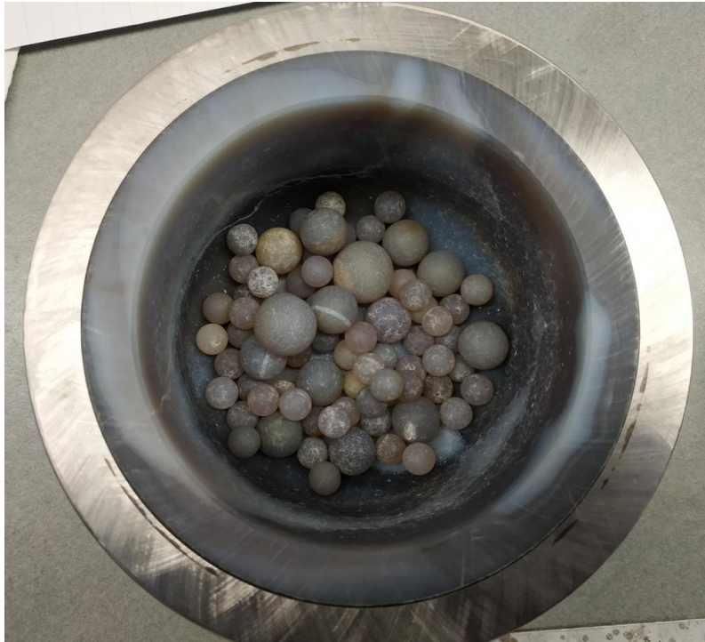
Εικόνα 25: Γουδί με 74 αλεστικά σφαιρίδια διαφορετικής διαμέτρου
