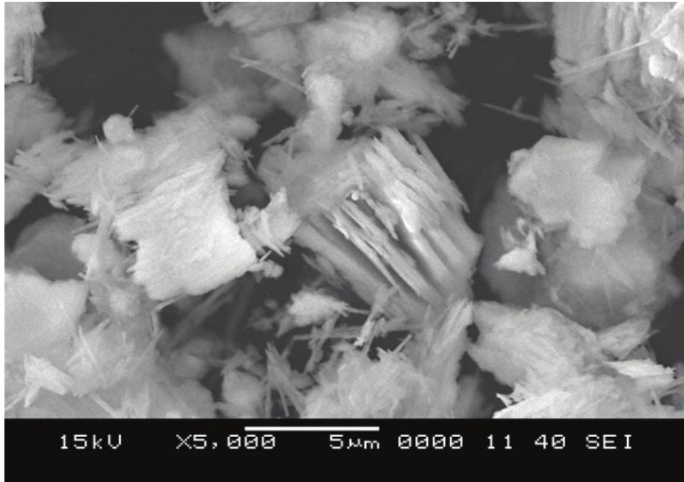
Εικόνα 8: Εικόνα από ανάλυση SEM μετακαολίνη έπειτα από θερμική επεξεργασία (31)
