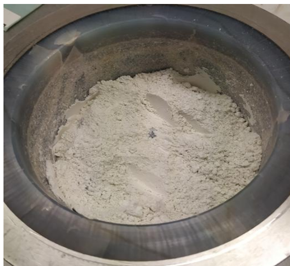
Εικόνα 26: Καολίνης Supreme μετά από λειοτρίβηση
