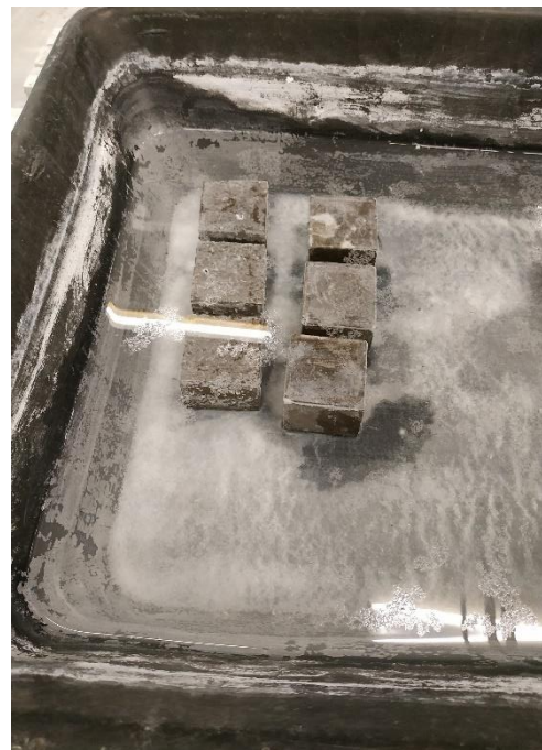
Εικόνα 4.3 Συντήρηση δοκιμίων μέσα στο νερό για 7 μέρες
