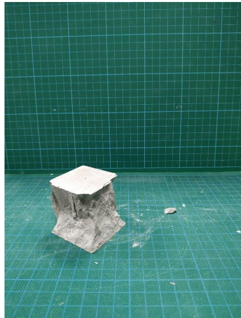
Εικόνα 4.10 Δοκίμιο αφότου αστοχήσει
