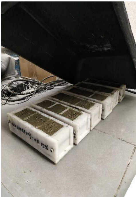
Εικόνα 4.2 Συντήρηση δοκιμίων σε περιβάλλον υγρασίας (1ο 24ωρο μετά την παραγωγή τους)
