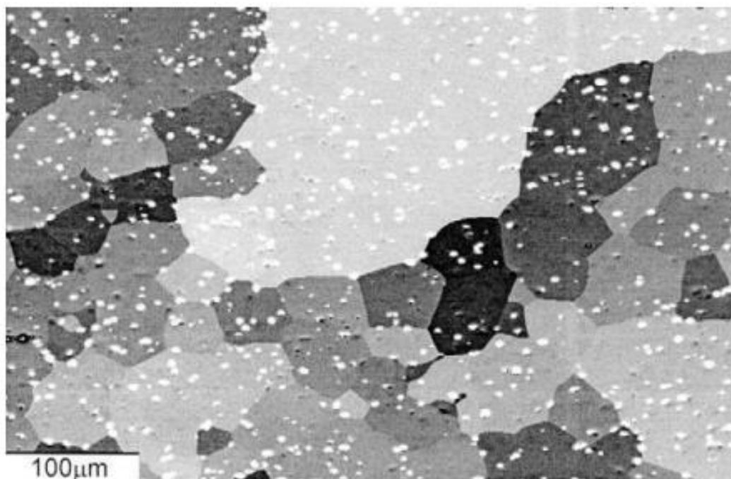
Σχήμα 44: Ακανόνιστη ανάπτυξη κόκκων μετά την ανακρυστάλλωση κατά την ανόπτηση του AA3004 της 600°C [1].
