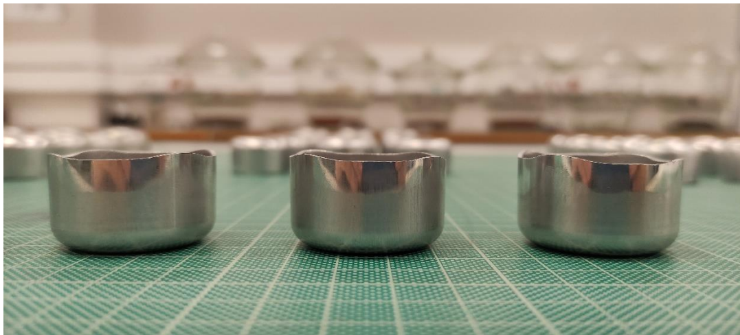
Σχήμα 12: Κιάθια που έχουν κοιλανθεί από ένα φύλλο AA3104 (H18), το οποίο χαρακτηρίζεται από έντονο κρυσταλλογραφικό ιστό παραμόρφωσης (έλασης). Χαρακτηριστική είναι η εμφάνιση του φαινομένου του «earing», όπου εμφανίζονται «αυτιά» στις 45°, 135°, 225°, 315° σε σχέση με την διεύθυνση της έλασης.
