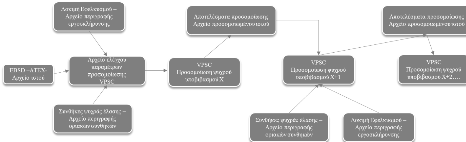
Σχήμα 72: α) Σημεία λήψης πειραματικών δεδομένων για την προσομοίωση των ψυχρών υποβιβασμών κατά την παραγωγική διαδικασία του AA3104 H26, β) Διασύνδεση αρχείων με τον κώδικα πολικρυσταλλικής πλαστικότητας VPSC για την προσομοίωση της εξέλιξης του κρυσταλλογραφικού ιστού κατά την ψυχρά έλαση του AA3104.
