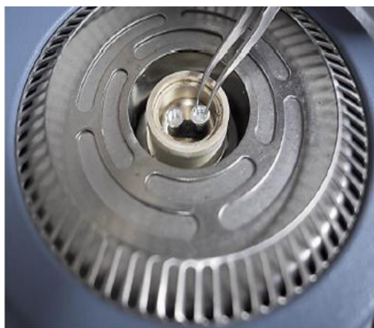
Εικόνα 4.2.1: Συσκευή DSCQ200 της εταιρίας TA Instruments (αριστερά). Καψίδια από αλουμίνιο τοποθετημένα εντός του φούρνου (δεξιά).
