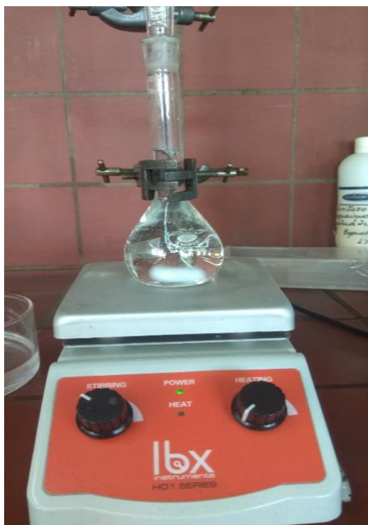
Εικόνα 5.1.3.1: Αριστερά σύστημα μαγνητικής ανάδευσης προς πλήρη διάλυση της χιτοζάνης και δεξιά το υδατόλουτρο όπου τοποθετούνται τα κρυσταλλωτήρια προς σχηματισμό των φίλμ.
