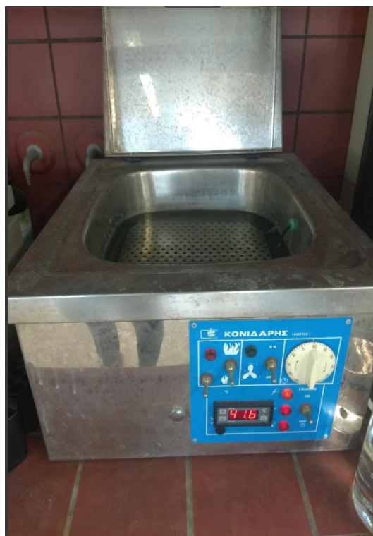
Εικόνα 5.1.3.1: Αριστερά σύστημα μαγνητικής ανάδευσης προς πλήρη διάλυση της χιτοζάνης και δεξιά το υδατόλουτρο όπου τοποθετούνται τα κρυσταλλωτήρια προς σχηματισμό των φίλμ.
