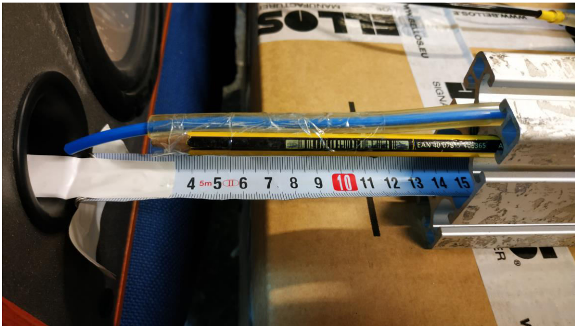
Σχήμα 4.17: Πειραματική διάταξη βαθμονόμησης, μεγέθυνση στην πηγή πίεσης.
