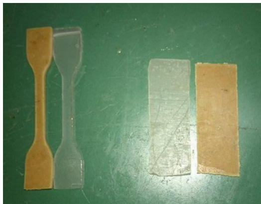
Σχήμα 3.5: Δοκίμια μετά την κοπή
