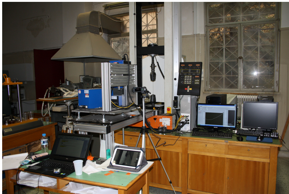
Σχήμα 2.1: Πειραματική διάταξη για τα πειράματα εφελκυσμού
