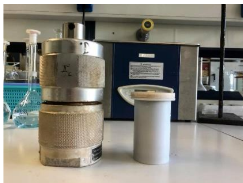
Εικόνα 4.7: Δοχείο Teflon και αυτόκλειστο δοχείου, όπου λαμβάνει χώρα η υδροθερμική αντίδραση.
