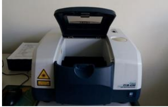
Εικόνα 4.11: Φασματόμετρο FT-IR JASCO 4200, το οποίο βρίσκεται στην Σχολή Χημικών Μηχανικών του Ε.Μ.Π.
