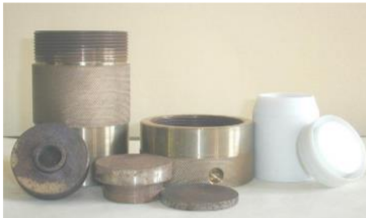
Εικόνα 2.5: Αυτόκλειστο δοχείο που χρησιμοποιείται για τη διεξαγωγή της υδροθερμικής ή διαλυτοθερμικής αντίδρασης.
