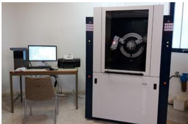
Εικόνα 4.9: Περιθλασίμετρο ακτίνων X Bruker D8 Advance, το οποίο βρίσκεται στην Σχολή Χημικών Μηχανικών του Ε.Μ.Π.
