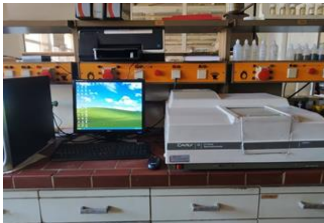
Εικόνα 4.15: Φασματοφωτόμετρο UV-Vis Varian Cary 50, το οποίο βρίσκεται στην Σχολή Χημικών Μηχανικών, Ε.Μ.Π.
