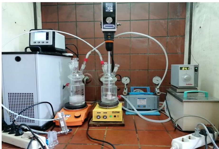
Εικόνα 2-1. Πειραματική διάταξη παραγωγής πολυμερών HEUR με συμβατικές μεθόδους θέρμανσης.
