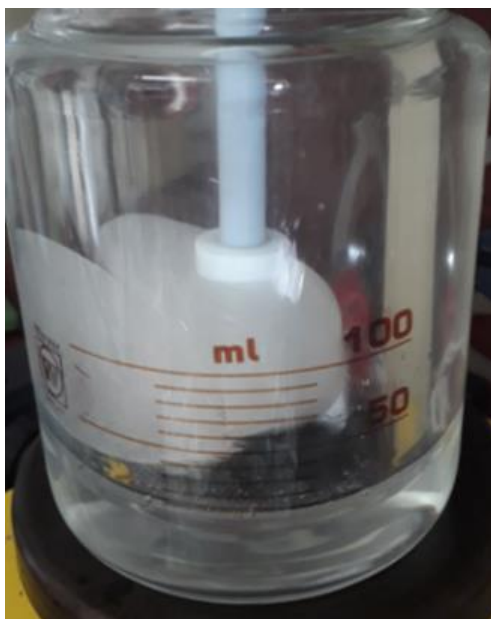
Εικόνα 3-1. Εικόνα φαινομένου αποκόλλησης του αντιδρώντος μείγματος από το τοίχωμα του αντιδραστήρα.
