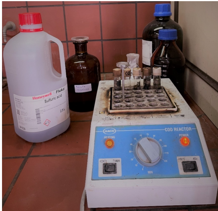
Εικόνα 13: Φούρνος στους 150 °C για θέρμανση των δειγμάτων και πραγματοποίηση της αντίδρασης μεταξύ οργανικού υλικού και διχρωμικού ιόντος
