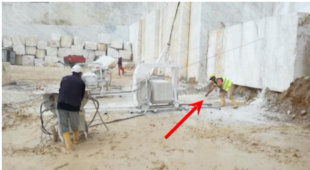
Εικόνα 4.3: Ξεκίνημα της συρματοκοπής με τράβηγμα του σύρματος (πηγή: Παπαδόπουλος, παρουσίαση «Κίνδυνοι από τη χρήση συρματοκοπών», 2018)
