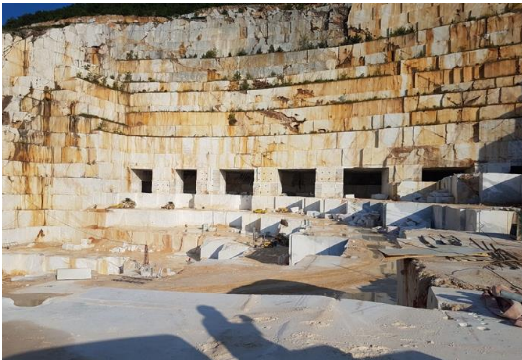
Εικόνα 3.7: Είσοδος στον υπόγειο χώρο εκμετάλλευσης του λατομείου ARISTON, η οποία εξελίσσεται με την μέθοδο θαλάμων και στύλων (πηγή: Ίδιο αρχείο από την Πρακτική Άσκηση II, Λατομείο ARISTON, 2019 )
