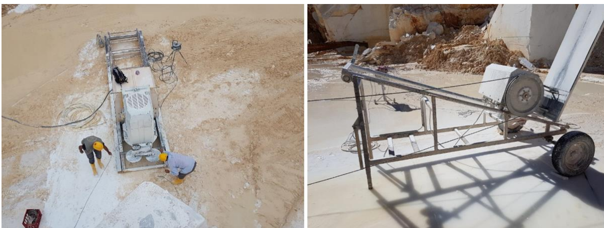
Εικόνα 3.4: Μηχανή συρματοκοπής για την απόσπαση των όγκων από το μητρικό πέτρωμα (αριστερά) και για τον ορθογωνισμό (δεξιά) (πηγή: Ίδιο αρχείο από την Πρακτική Άσκηση II, Λατομείο ARISTON, 2019 ).
