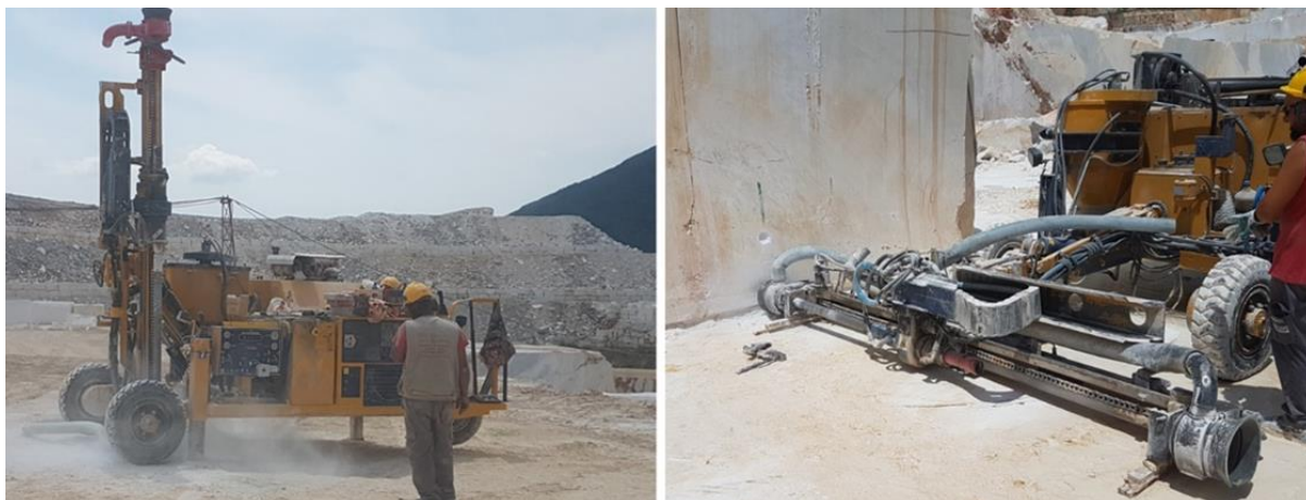
Εικόνα 3.3: Διατρητικό τρυπάνι για την διάνοιξη κάθετων (αριστερά) και οριζόντιων (δεξιά) διατρημάτων στο μητρικό πέτρωμα (πηγή: Ίδιο αρχείο από την Πρακτική Άσκηση II, Λατομείο ARISTON, 2019 ).
