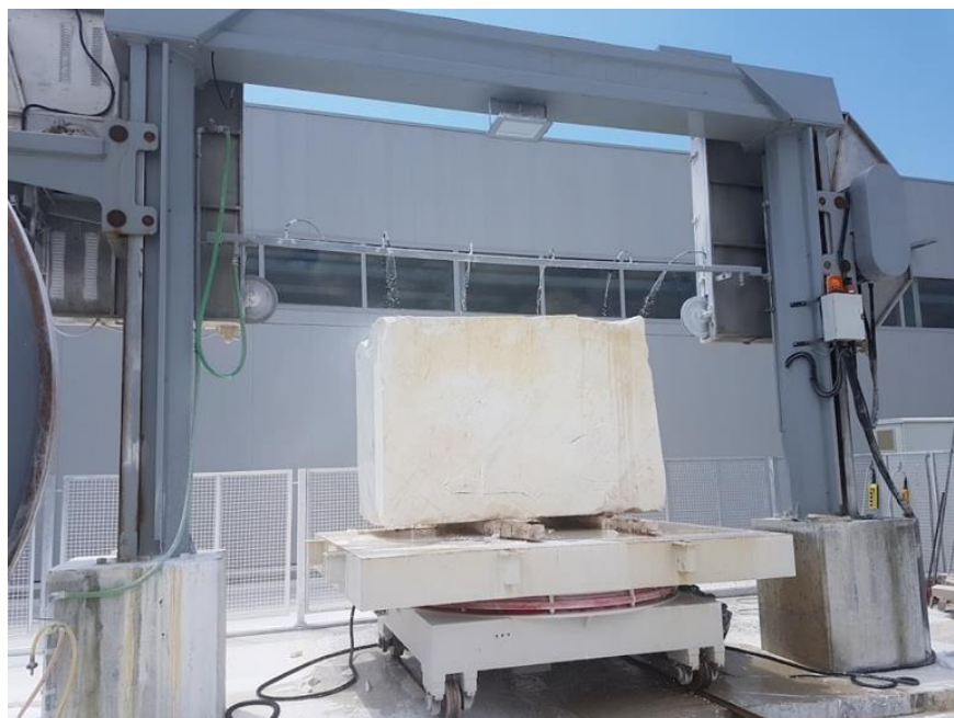
Εικόνα 3.6: Ορθογωνισμός όγκου μαρμάρου με μονόσυρμα (πηγή: Ίδιο αρχείο από την Πρακτική Άσκηση II, Σχιστήριο ARISTON, 2019 )
