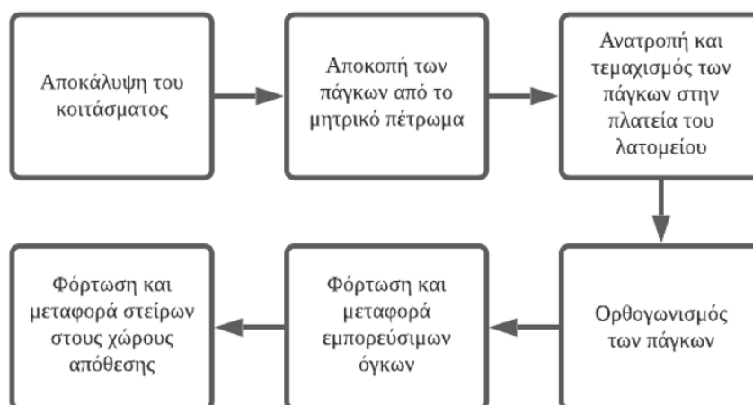
Σχήμα 3.1: Σειρά των κύριων εργασιών επί των όγκων μαρμάρου σε λατομεία μαρμάρου, ίδια επεξεργασία.
