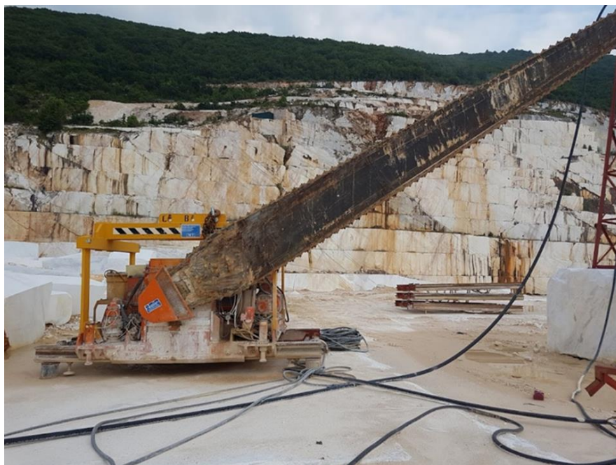
Εικόνα 3.5: Εξορυκτικό αλυσοπρίονο υπαίθριων εκμεταλλεύσεων (πηγή: Ίδιο αρχείο από την Πρακτική Άσκηση II, Λατομείο ARISTON, 2019 ).
