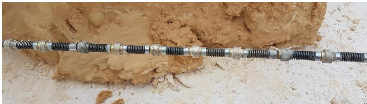
Εικόνα 4.1: Αδαμαντοφόρο σύρμα που χρησιμοποιείται σε μηχανές συρματοκοπής για την εξόρυξη μαρμάρου (πηγή: Ίδιο αρχείο, λατομείο ARISTON, 2019).
