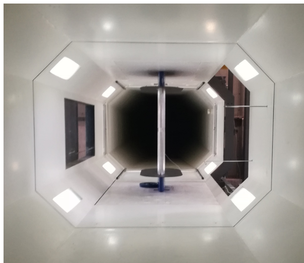
Σχήμα 2.1: Το μοντέλο πτέρυγας τοποθετημένο κατακόρυφα μέσα στο χώρο δοκιμών της αεροδυναμικής σήραγγας
