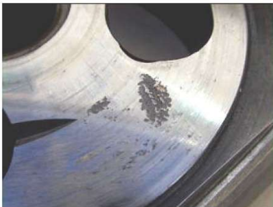
Σχήμα 99. Σπηλαιώση στην πλάκα πίεσης της αντλίας
