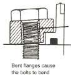
Σχήμα 28. Υπερβολικό σφίξιμο των μπουλονιών προκαλεί κάμψη της φλάντζας
