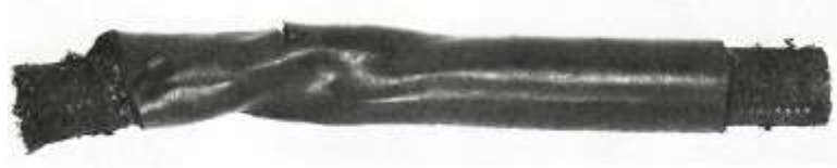
Σχήμα 39. Στρεπτική καταπόνηση προκάλεσε την αστοχία της ελαστικής σωλήνωσης
