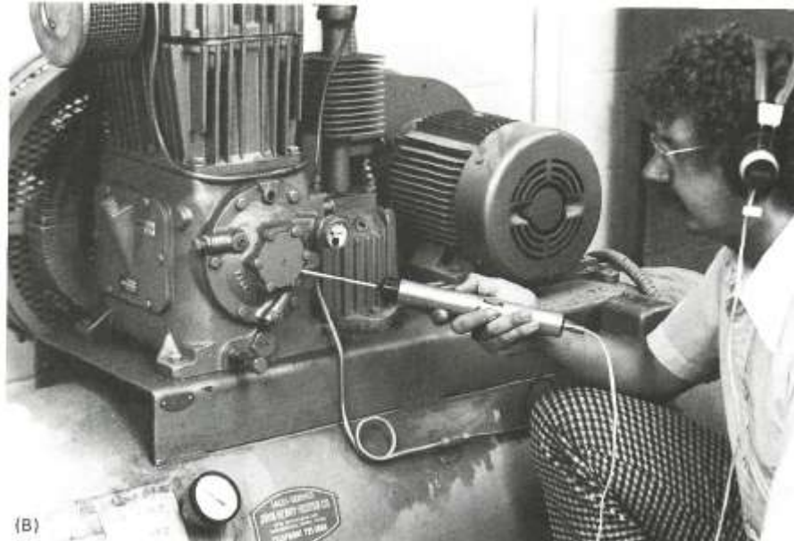
Σχήμα 248. υπερηχητικός ανιχνευτής διαρροών χρησιμεύει σαν αισθητήρας κραδασμών
