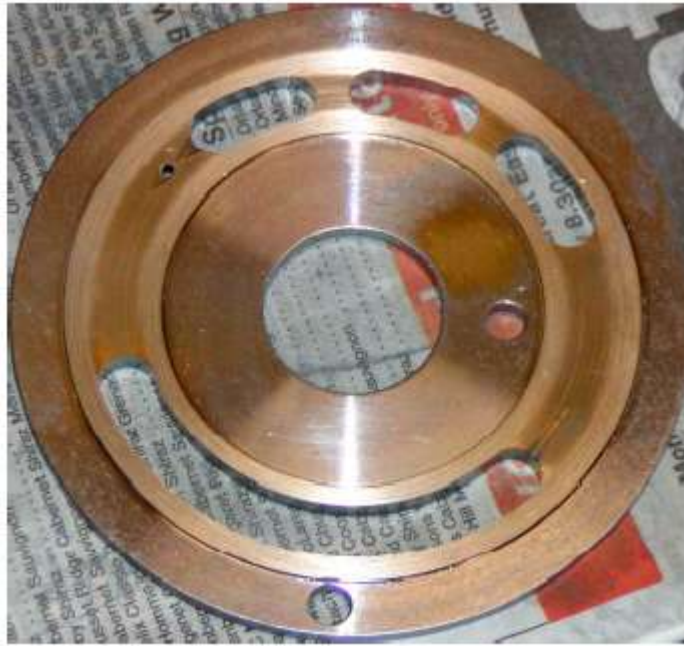
Σχήμα 72. Ομοίως χαρακίες πάνω στην πλάκα πίεσης
