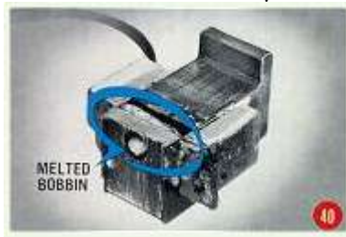
Σχήμα 176. Λιωμένη μπομπίνα πηνίου λόγω υπερθέρμανσης
