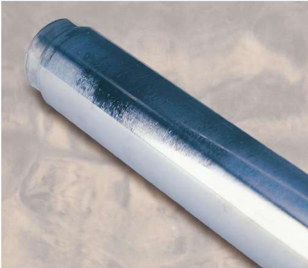
Σχήμα 209. Γδαρσίματα κοντά στο άκρο του βάρου τα οποία προέρχονται από την επιβολή υπερβολικών πλευρικών φορτίων πάνω του.
