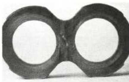
Σχήμα 128. Διαβρωμένη πλάκα οδοντωτής αντλίας από μολυσμένο υδραυλικό ρευστό το οποίο μετακινούσαν τα δόντια των γραναζιών.
