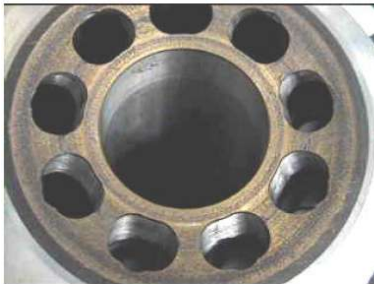
Σχήμα 108. Αποχρωματισμός και σπάσιμο λόγω υπερθέρμανσης ενός κυλίνδρου εμβόλων χάλκινου χρώματος που περιέχει τα έμβολα εξαιτίας ύπαρξης αέρα στο ρευστό.
