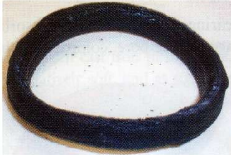
Σχήμα 111. Κατεστραμμένο στεγανωτικό εμβόλου εξαιτίας του φαινομένου diesel
