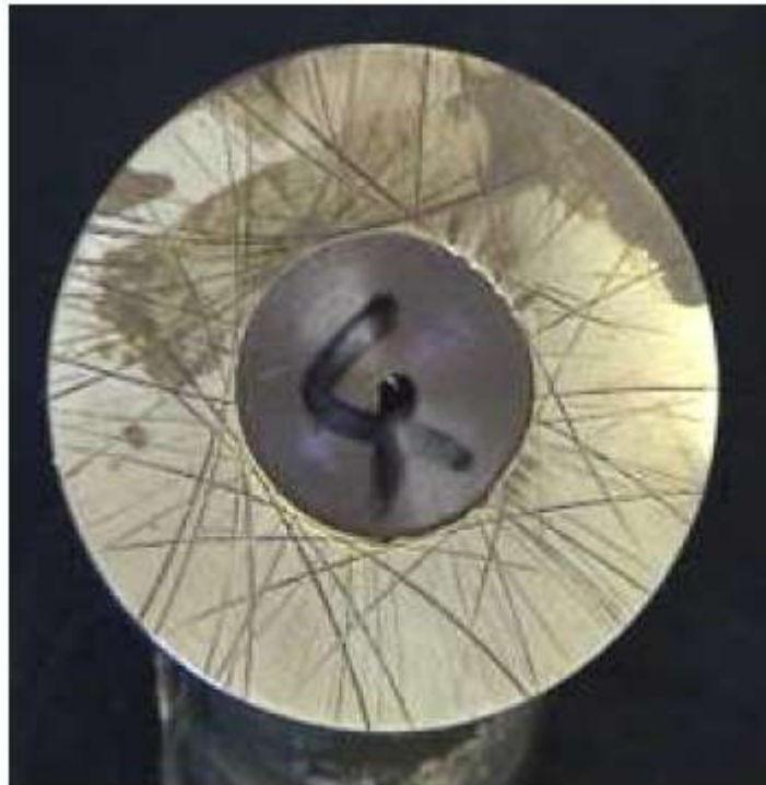
Σχήμα 123. Έντονες εκδορές σε υποδοχέα κεφαλής εμβόλου
