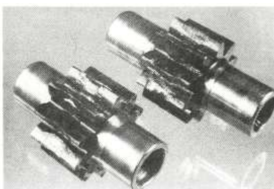
Σχήμα 133. Ένα μεγάλο και σκληρό κομμάτι κάποιου υλικού το οποίο βρισκόταν σαν ρυπαντής στο υδραυλικό λαδί κατέστρεψε ολοκληρωτικά τα δόντια των γραναζιών μιας γραναζωτής αντλίας.
