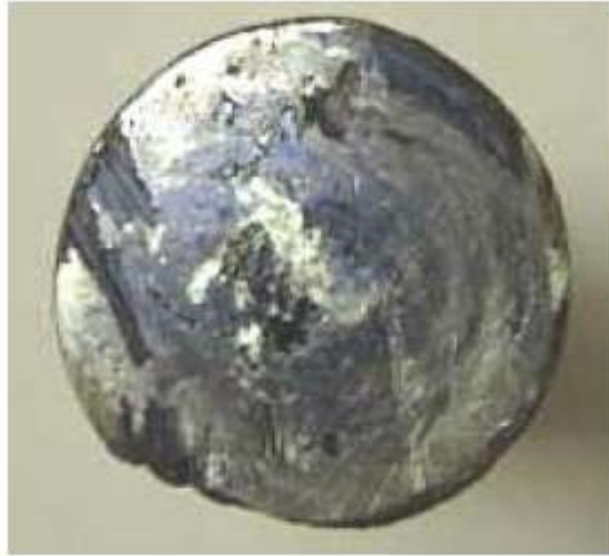
Σχήμα 117. Καταστροφή της υποδοχής του εμβόλου από έλλειψη υδροστατικής ισορροπίας
