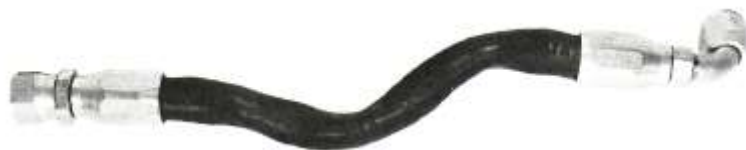
Σχήμα 43. Η ελαστικής σωλήνωση έχει καμφθεί ή συμπιεστεί σε διάφορα σημεία
