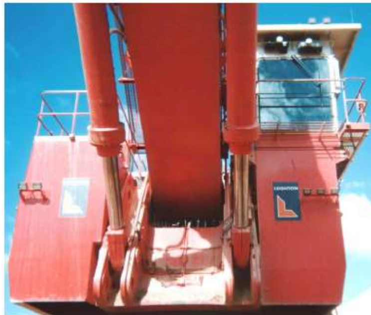
Σχήμα 112. Κύλινδροι με μεγάλη διάμετρο οι οποίοι δέχονται πολύ υψηλές πιέσεις είναι πολύ πιθανό να εμφανίσουν το φαινόμενο diesel
