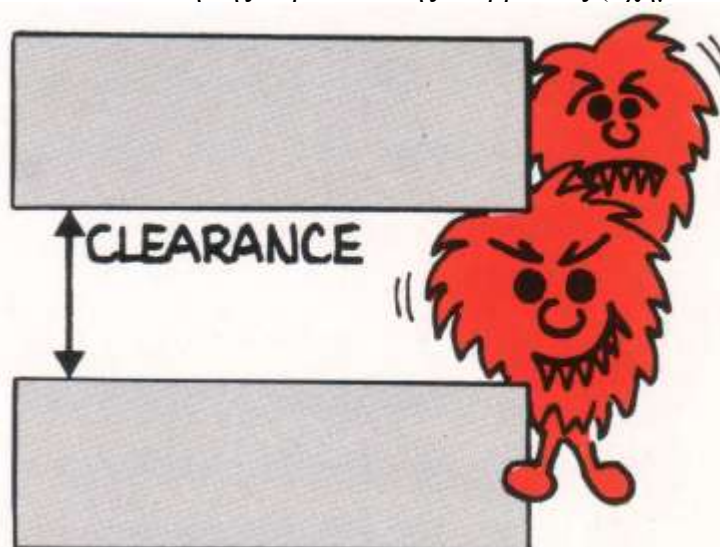
Σχήμα 84. Σωματίδια που έχουν μεγαλύτερο μέγεθος από τις εσωτερικές χάρες των εξαρτημάτων
