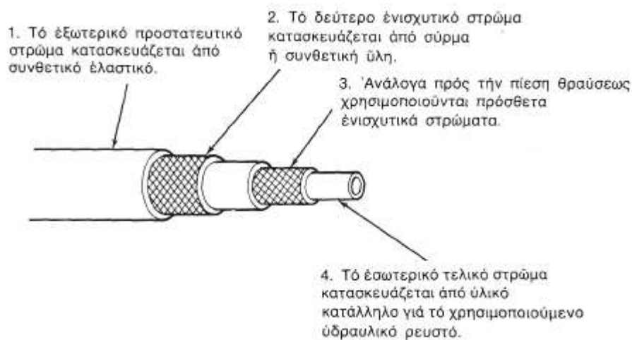
Σχήμα 34. Η κατασκευή του ελαστικού σωλήνα αποτελείται από αλλεπάλληλα στρώματα σύνθετου ελαστικού και πλεγμάτων
