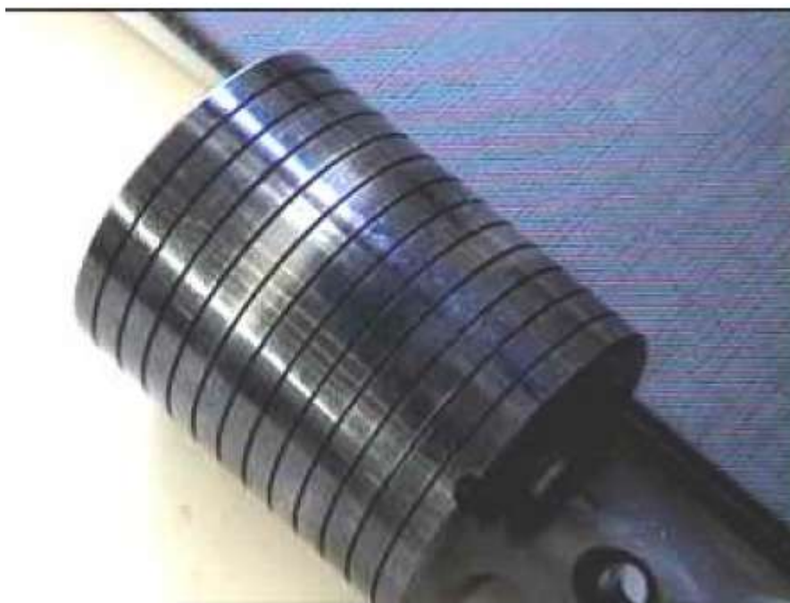
Σχήμα 119. Δακτύλιοι στο έμβολο που βοηθούν στην διατήρηση της υδροστατικής ισορροπίας
