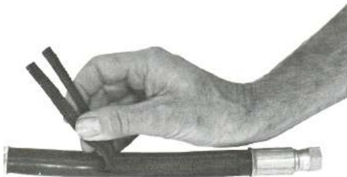
Σχήμα 37. Αστοχία ελαστικής σωλήνωσης εξαιτίας άσκησης υπερβολικής πίεσης πάνω της
