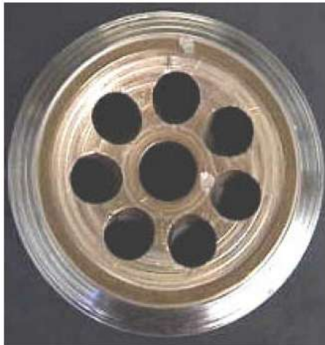
Σχήμα 86. Φθορά σε κύλινδρο εμβόλων εξαιτίας "3 body abrasion"
