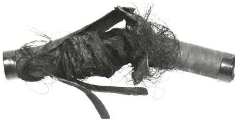
Σχήμα 42. Ελαστική σωλήνωση πολύ μικρή για τη δεδομένη εφαρμογή
