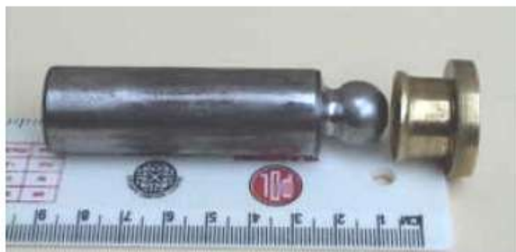
Σχήμα 101.Υποδοχή ολίσθησης αποσυνδεδεμένη από το έμβολο
