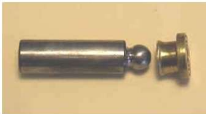
Σχήμα 109. Η υποδοχή αποχωρίζεται από τη σφαιρική κεφαλή του εμβόλου εξαιτίας ανεπαρκούς λίπανσης στον κύλινδρο μέσα στον οποίο ολισθαίνουν τα έμβολα.
