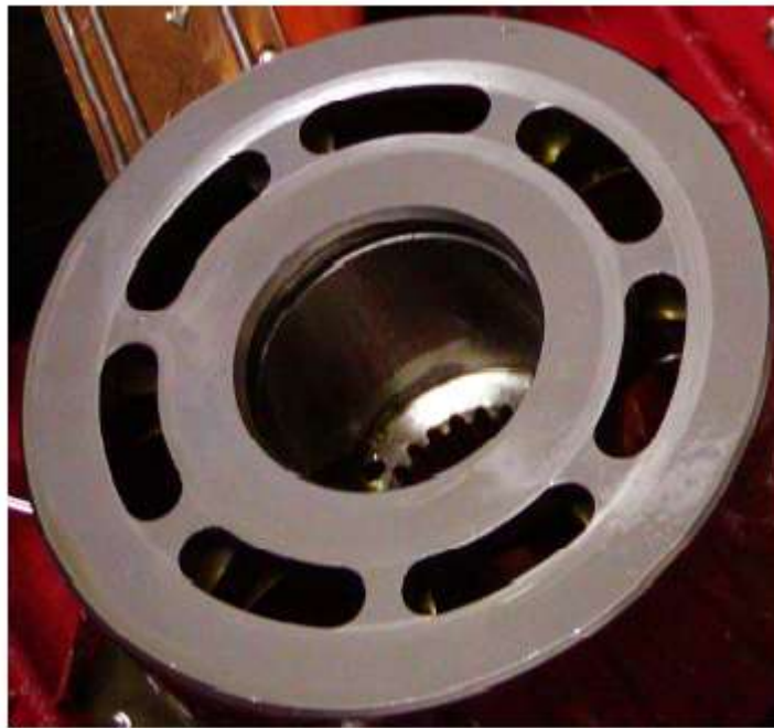
Σχήμα 71 .Γδάρσιμο στο σώμα των κυλίνδρων που προέρχεται από διαχωρισμό
