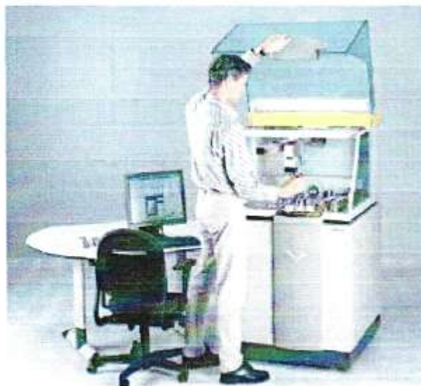
Σχήμα 235. Διάταξη XRF φασματοσκοπίας
