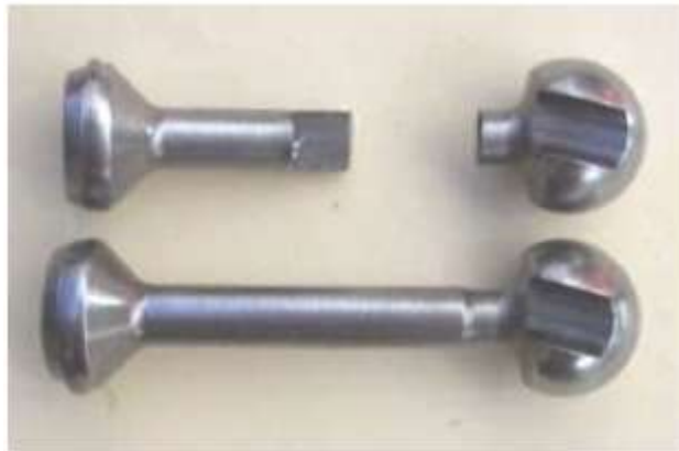
Σχήμα 106. Αστοχία εμβόλων αντλιών τεθλασμένου άξονα
