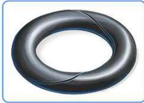
Σχήμα 47. Σπειροειδής βλάβη του στεγανωτικού δακτυλίου
