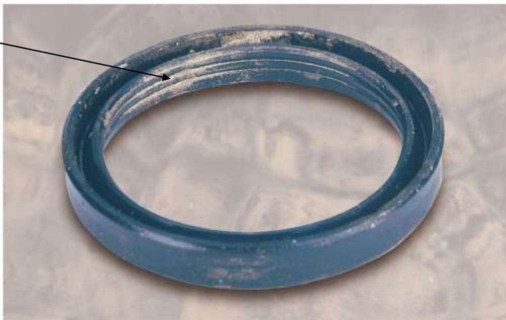
Σχήμα 210. Με την επιβολή πλευρικών φορτίων τα στεγανωτικά φθείρονται μόνο στη μια πλευρά τους.
