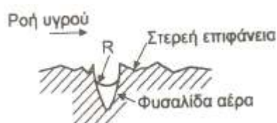
Σχήμα 96. Ανάπτυξη φυσαλίδας ατμού σε μικροεσοχή της στερεής επιφάνειας
