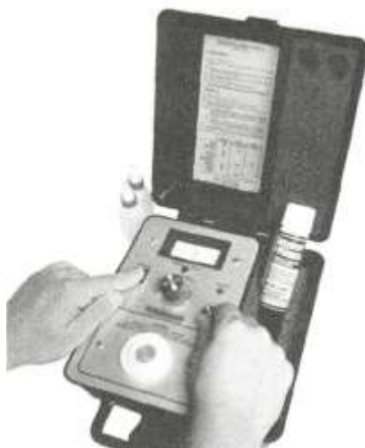
Σχήμα 246. . Ελεγκτής κατάστασης υδραυλικού ελαίου
