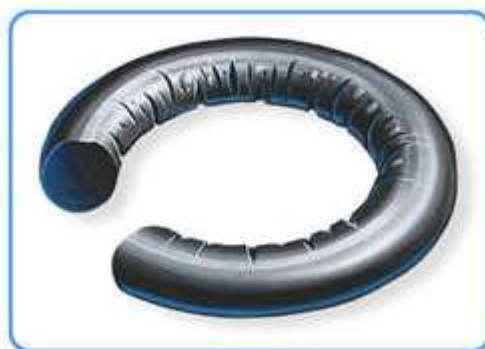
Σχήμα 46.Καταστροφή στεγανωτικού λόγω ακατάλληλης θερμοκρασίας
