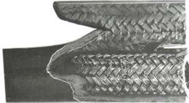
Σχήμα 36. Αστοχία σωλήνωσης εξαιτίας συχνών παλμών πίεσης
