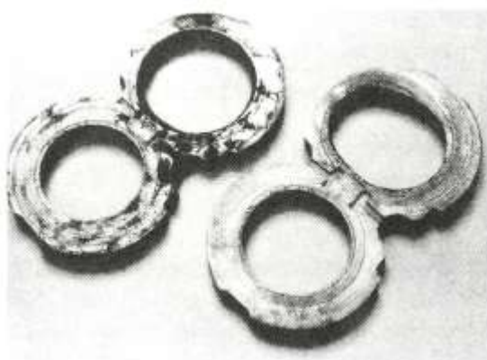
Σχήμα 134. Τραχιά πετραδάκια/ χαλίκια καταστρέφουν και την πλάκα πίεσης και τη γραναζωτή αντλία στην οποία ανήκουν.
