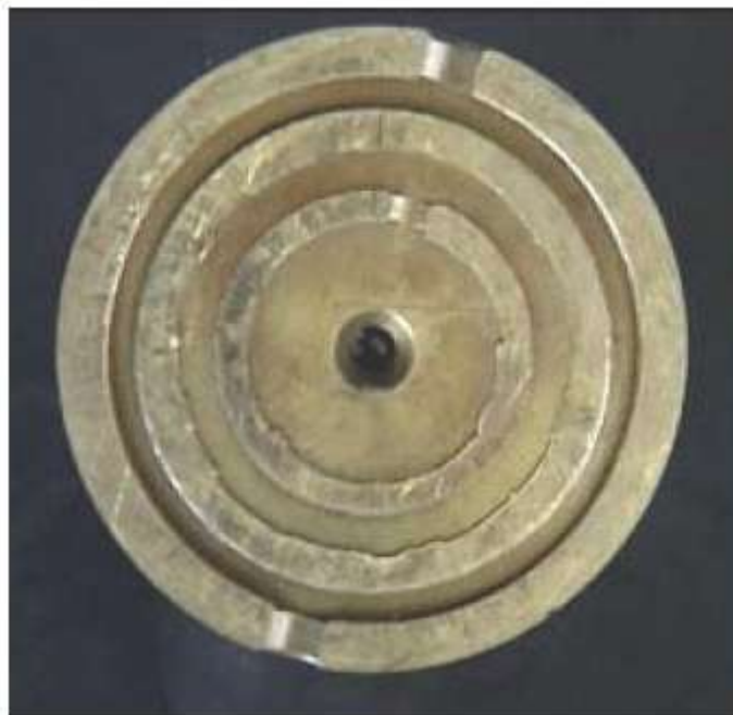
Σχήμα 122. Φθορά υποδοχέα από την έλλειψη υδροστατικής ισορροπίας
