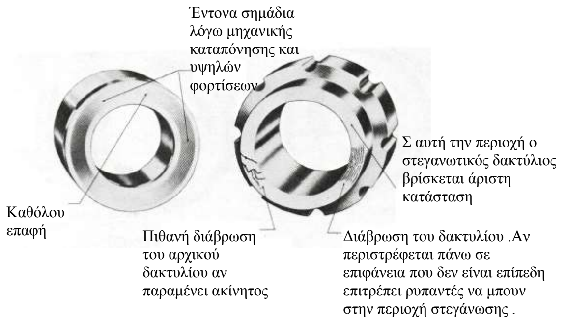
Σχήμα32.Μηχανική καταπόνηση παρεμβασμάτων
