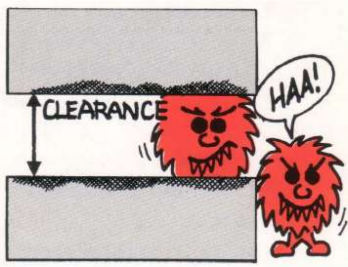
Σχήμα 85. Σωματίδια που έχουν το ίδιο μέγεθος με τις εσωτερικές χάρες των εξαρτημάτων προκαλούν "3 body abrasion"
