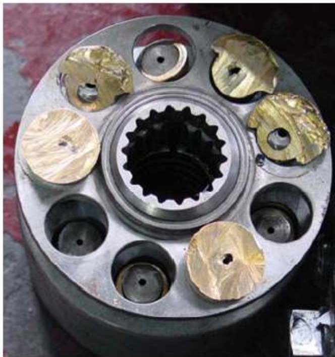
Σχήμα 103. Κατεστραμμένες υποδοχές εμβόλων εξαιτίας σπηλαιώσης.
