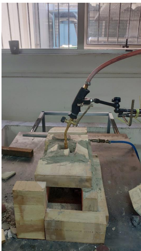
Εικόνα 2.3 επένδυση του φούρνου με κυάθιο χύτευσης
