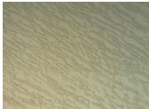
Εικόνα 3.30 15N20-1084 βαφή σε νερό (x500)
