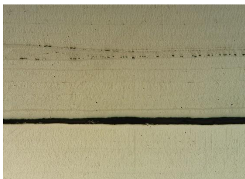
Εικόνα 3.17 15N20-1084 βαφή σε λάδι (x50)
