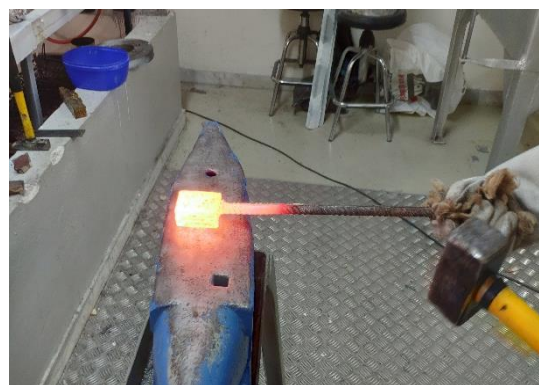
Εικόνα 2.16 τεμάχιο έτοιμο για πρώτη θερμή συγκόλληση
