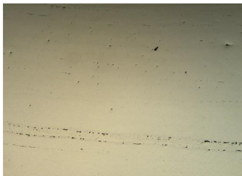
Εικόνα 3.22 15N20-1095 βαφή σε νερό (x100)
