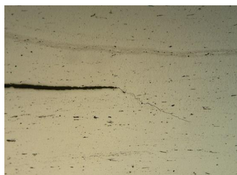
Εικόνα 3.14 15N20-1095 βαφή σε λάδι (x100)
