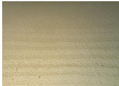
Εικόνα 3.28 15N20-1084 βαφή σε νερό (x100)
