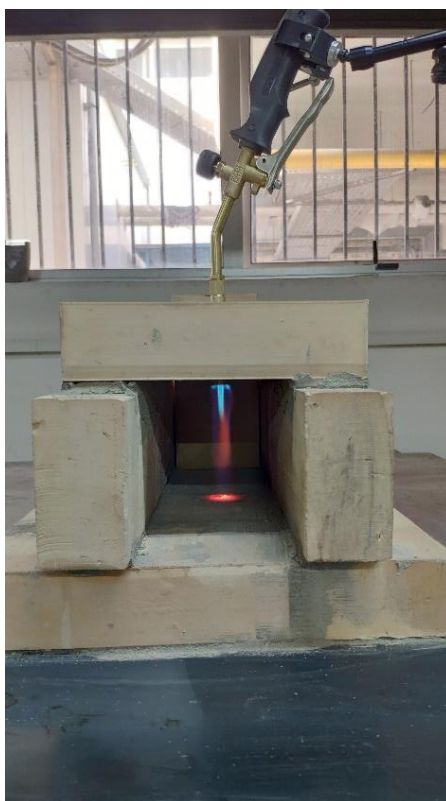
Εικόνα 2.6 το πρώτο φλόγιστρο στον αρχικό φούρνο
