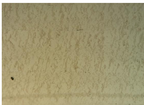
Εικόνα 3.19 15N20-1084 βαφή σε λάδι (x200)
