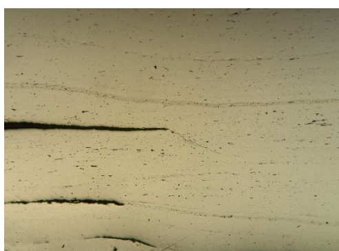
Εικόνα 3.13 15N20-1095 βαφή σε λάδι (x50)
