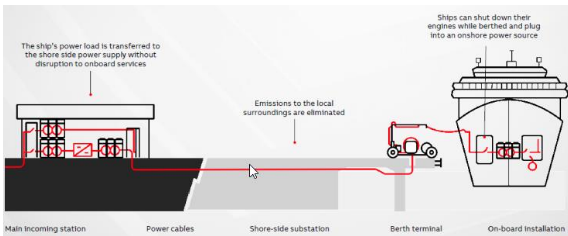
Εικόνα 3-6: Ολοκληρωμένη εγκατάσταση ψυχρής εκκίνησης πλοίου-λιμένα ( https://library.adbb.com/ ).
