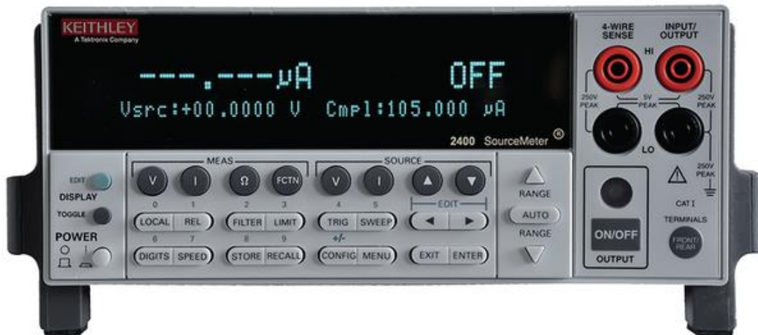
Εικόνα 31. Το σύστημα μέτρησης αντιστάσεων Keithley 2400
