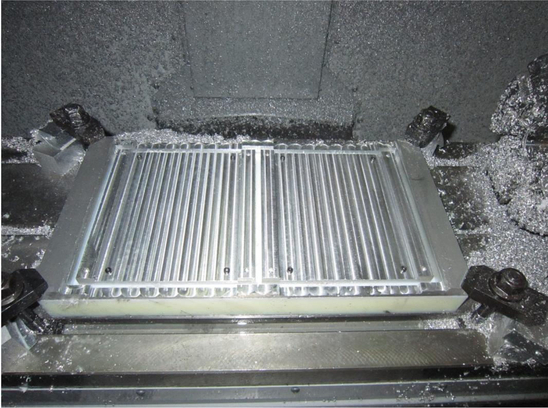
Κατασκευή όμοιων κομματιών μεγάλου μεγέθους από ένα μπλοκ υλικού.
