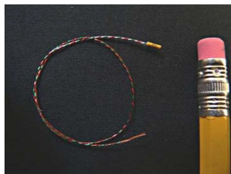
Δίπλα φαίνεται θερμοστοιχείο που τοποθετείται στο κύκλωμα υδρόψυξης. Αυτό χρησιμοποιείται ως διαγνωστικό εργαλείο στο πρωτότυπο για να ελέγχουμε τη θερμοκρασία του ψυκτικού μέσου από και προς τις ψύκτρες.
