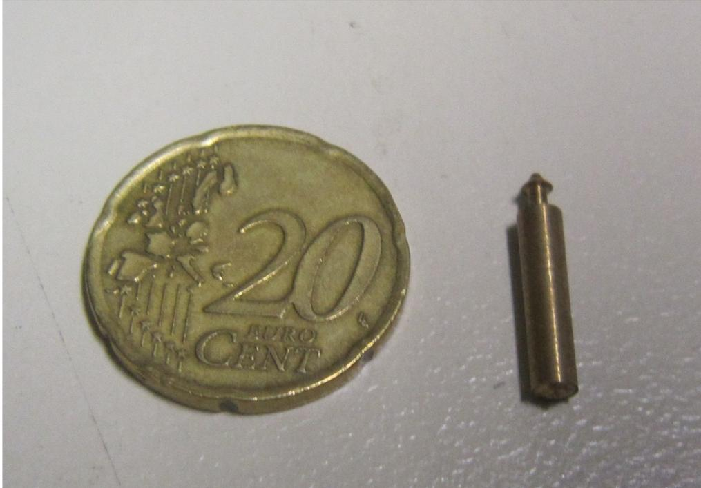
Δοκιμή κατασκευής της ακμής του εμβόλου για το σύστημα διαχείρισης υγρών της πλατφόρμας. Η κατασκευή πρωτοτύπου αποδείχθηκε σωστή επιλογή για αυτό το κομμάτι γιατί μας εμφάνισε τα αδύναμα σημεία του σχεδιασμού και έγινε τροποποίηση του σχεδίου ώστε το τελικό τεμάχιο να ταιριάζει στα παρεμβύσματα που έχουν αγοραστεί.
