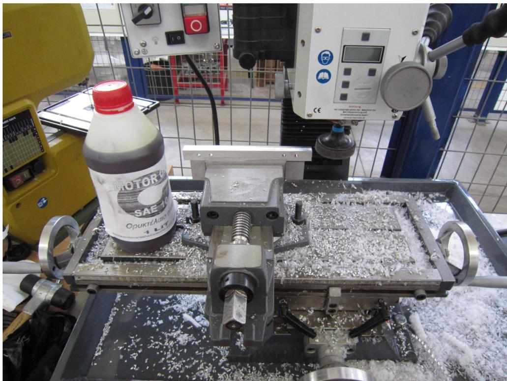
Λείανση αλουμινίου στο φρεζοδράπανο. Χρησιμοποιείται αρχικά σμυριδοτροχός (polishing) και έπειτα κετσές με πάστα λείανσης (buffing).
