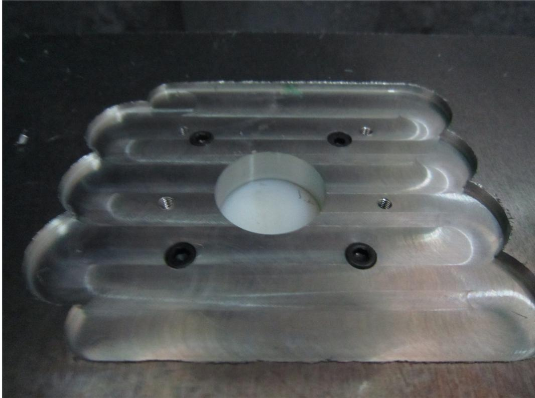
Οι οπές με ανοχή στη διάμετρο κατασκευάζονται είτε με γλύφανο, είτε, για μεγάλες διαστάσεις ή μικρό βάθος, με κοπή προφίλ. Πάνω φαίνεται διαμόρφωση για υποδοχή λαιμού κινητήρα που χρειάζεται ανοχή.
