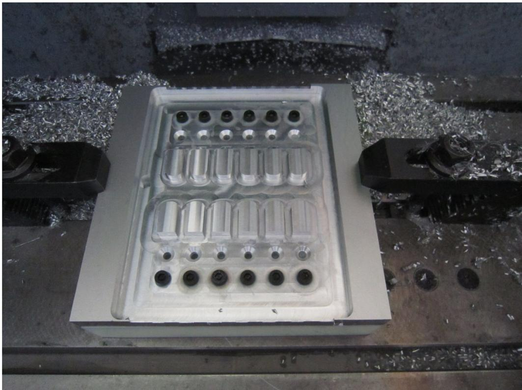
Κατασκευή 6 όμοιων κομματιών από ένα μπλοκ υλικού.
