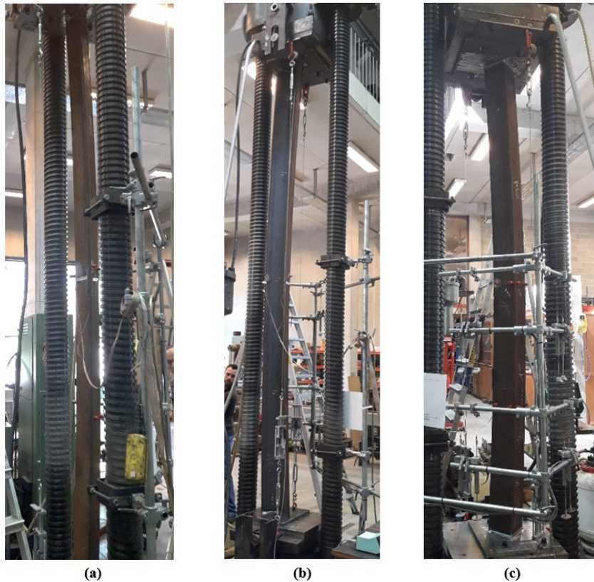
Σχήμα 16: Τελική παραμορφωμένη μορφή του (a) Sp15 λόγω καμπτικού λυγισμού (b) Sp26 λόγω στρεπτοκαμπτικού λυγισμού και (c) Sp14 λόγω μικτής αστοχίας μεταξύ καμπτικού και στρεπτοκαμπτικού λυγισμού
