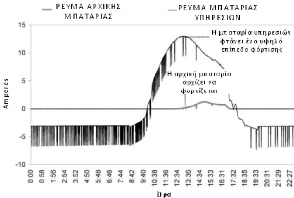
Διάγραμμα 6: Ρεύμα της αρχικής μπαταρίας και της μπαταρίας υπηρεσιών κατά τη διάρκεια μιας τυπικής καλοκαιρινής ημέρας, στην οποία το πρωτότυπο έμεινε σταθμευμένο όλη την ημέρα
