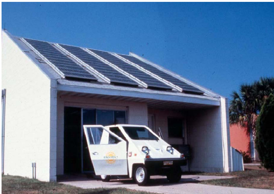
Εικόνα 45: CityCar EV που φορτίζεται από φωτοβολταϊκή συστοιχία
