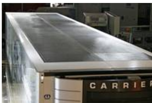
Εικόνα 15: Solarion AG. Χρησιμοποιήθηκαν 30 ηλιακοί συλλέκτες CIGS
