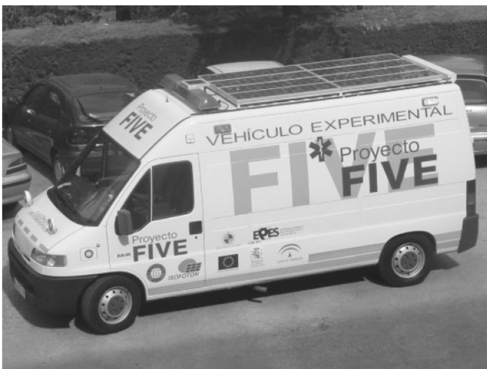
Εικόνα 4: Πρωτότυπο ασθενοφόρου με Φ/Β διάταξη ενσωματωμένη στην οροφή του
