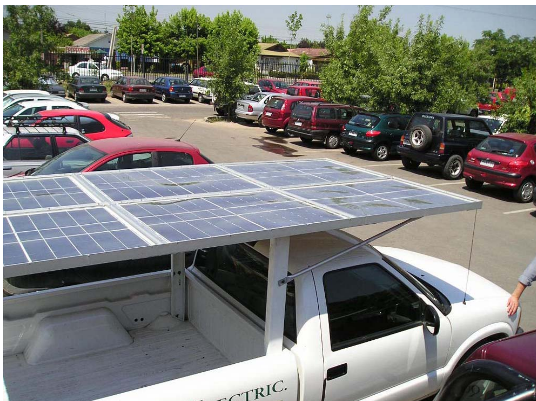
Εικόνα 38: EV με 6 φωτοβολταϊκά πάνελ εγκαταστημένα στην οροφή
