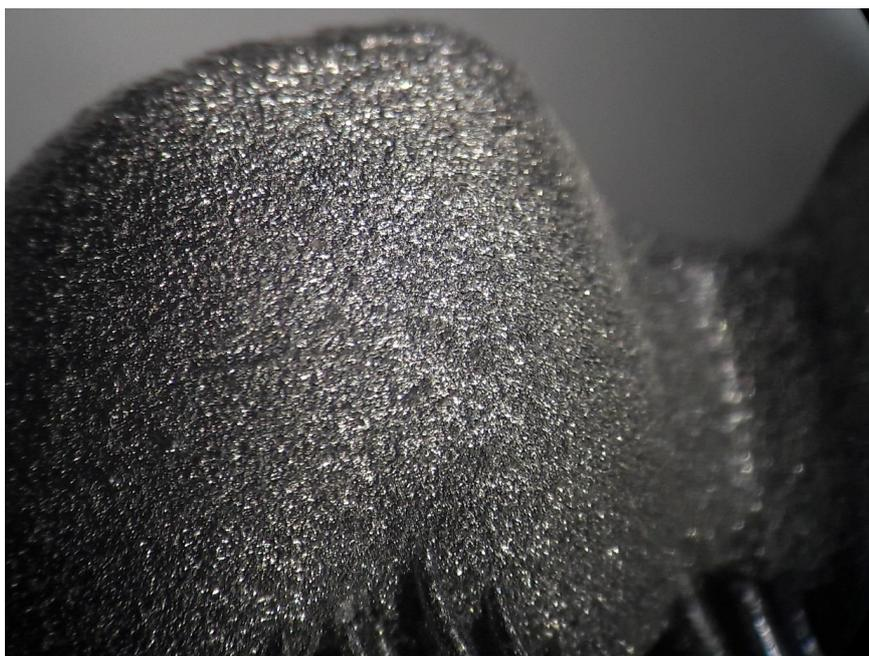
**Εικόνα 12.** Επιφάνεια αντικειμένου κατασκευασμένου με την μέθοδο SLM πριν το φινίρισμα της επιφάνειας.
