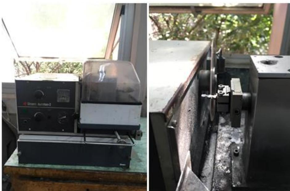
**Εικόνα 15.** Μικροτόμος Struers Accutom-2 και διαδικασία κοπής δειγμάτων
