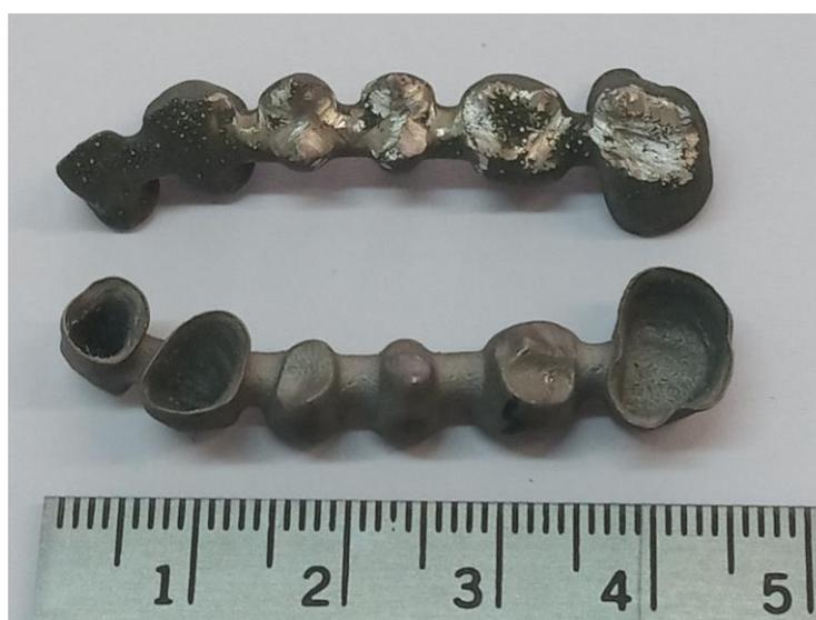
**Εικόνα 14.** Δείγματα CoCr κατασκευασμένα με μέθοδο SLM.
