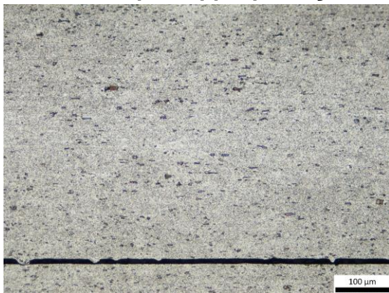
Σχήμα 72 Οπτική μικρογραφία δείγματος 0,50mm «T+40°C» κατόπιν προσβολής HF σε μεγέθυνση x200.
