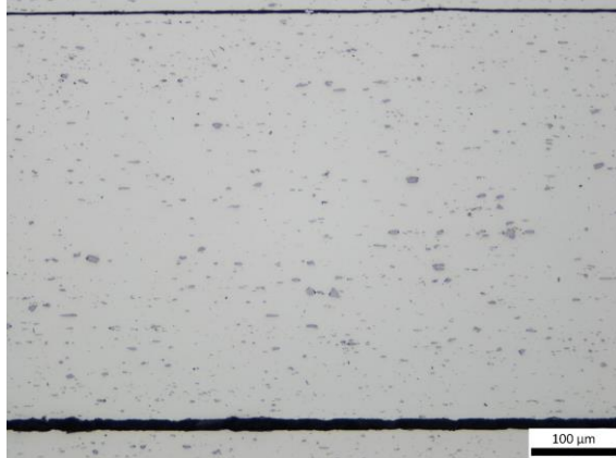
Σχήμα 55 Οπτική μικρογραφία δείγματος 0,50mm «T+40°C» κατόπιν στίλβωσης σε μεγέθυνση x200.
