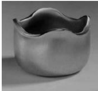
Σχήμα 29 «Λοβοί» δοκμίου κατόπιν της διεργασίας βαθιάς κοίλανσης [17].
