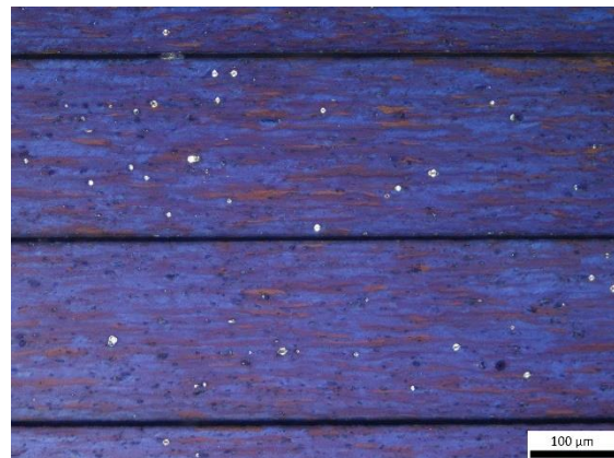
Σχήμα 180 Οπτική μικρογραφία δείγματος 0,20mm «20s – T 1 +10°C» κατόπιν προσβολής Bakers σε μεγέθυνση x200.
