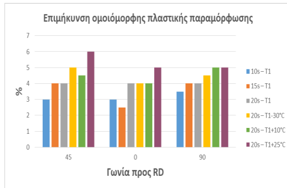
Σχήμα 217 Διάγραμμα που απεικονίζει την επιμήκυνση ομοιόμορφης πλαστικής παραμόρφωσης (Uniform Elongation) μελέτης B.
